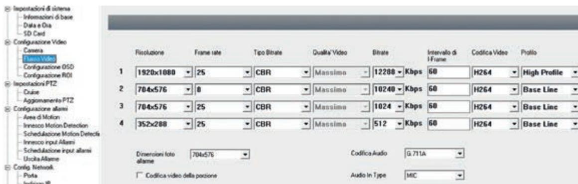
Esempio di schermata con i parametri: compressione video, risoluzione, qualità video, framerate, bitrate
