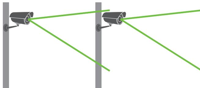
In generale è consigliabile evitare di puntare la telecamera verso sorgenti di luce intensa, come fari d'illuminazione notturna, per evitare l'abbagliamento della ripresa. Inoltre è sconsigliata l'installazione in prossimità di fonti luminose per evitare le interferenze degli insetti attirati dalla luce, che nel caso di sistemi con analisi video potrebbero causare falsi allarmi.
