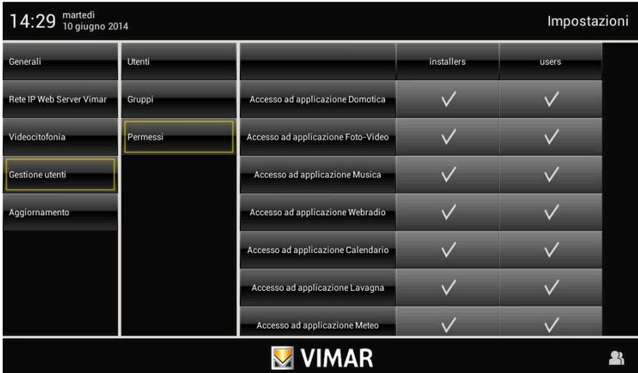
Al tocar el icono
