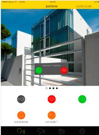
A cada **cámara** es posible asociar una imagen representativa, que se puede seleccionar en la galería o sacando una foto con la propia cámara. Además, si hay varias cámaras en la instalación, es posible activar una visualización en secuencia de las mismas tras configurar el tiempo de persistencia deseado.
