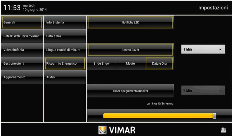
Al tocar los iconos correspondientes es posible activar el apagado de la pantalla y el salvapantallas configurando el tipo y el correspondiente tiempo antes de la activación.
