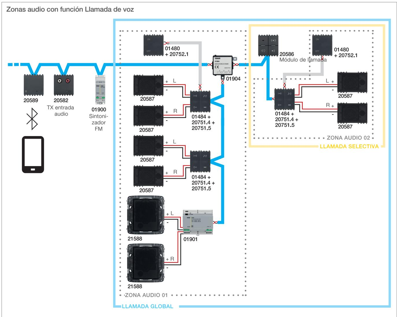
**Dispositivos configurados:** 1 entrada audio 20582, 1 sintonizador FM 01900 y 1 interfaz *Bluetooth technology* 30495-20589 (módulos transmisores), 4 amplificadores audio 30484-01484 y 01901 (módulos receptores) con las correspondientes teclas de mando 20751.4 y 20751.5, 2 mandos By-me 30480-01480 y 1 módulo de llamada 20586.
