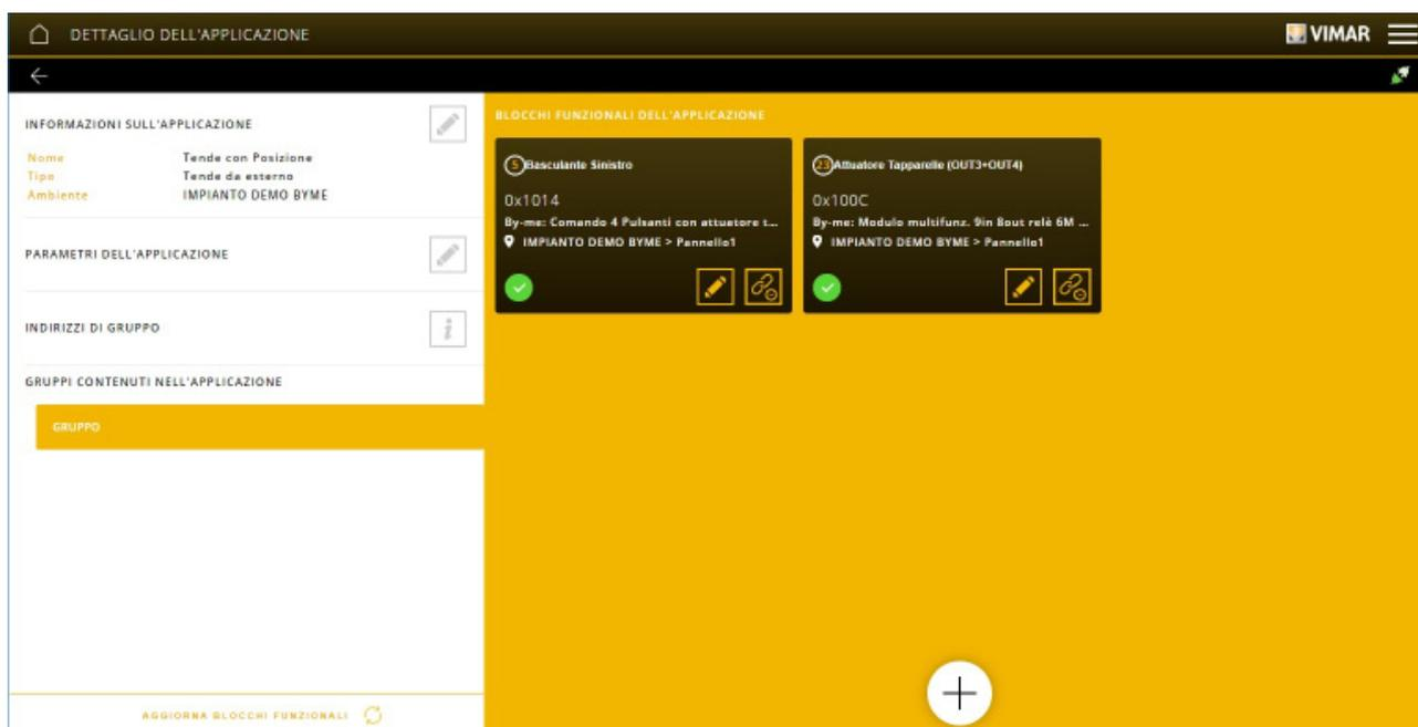
La aplicación ahora es completa y al apretar el pulsador basculante izquierdo se acciona el relé del actuador de persianas del módulo entradas/salidas 01470.1.
