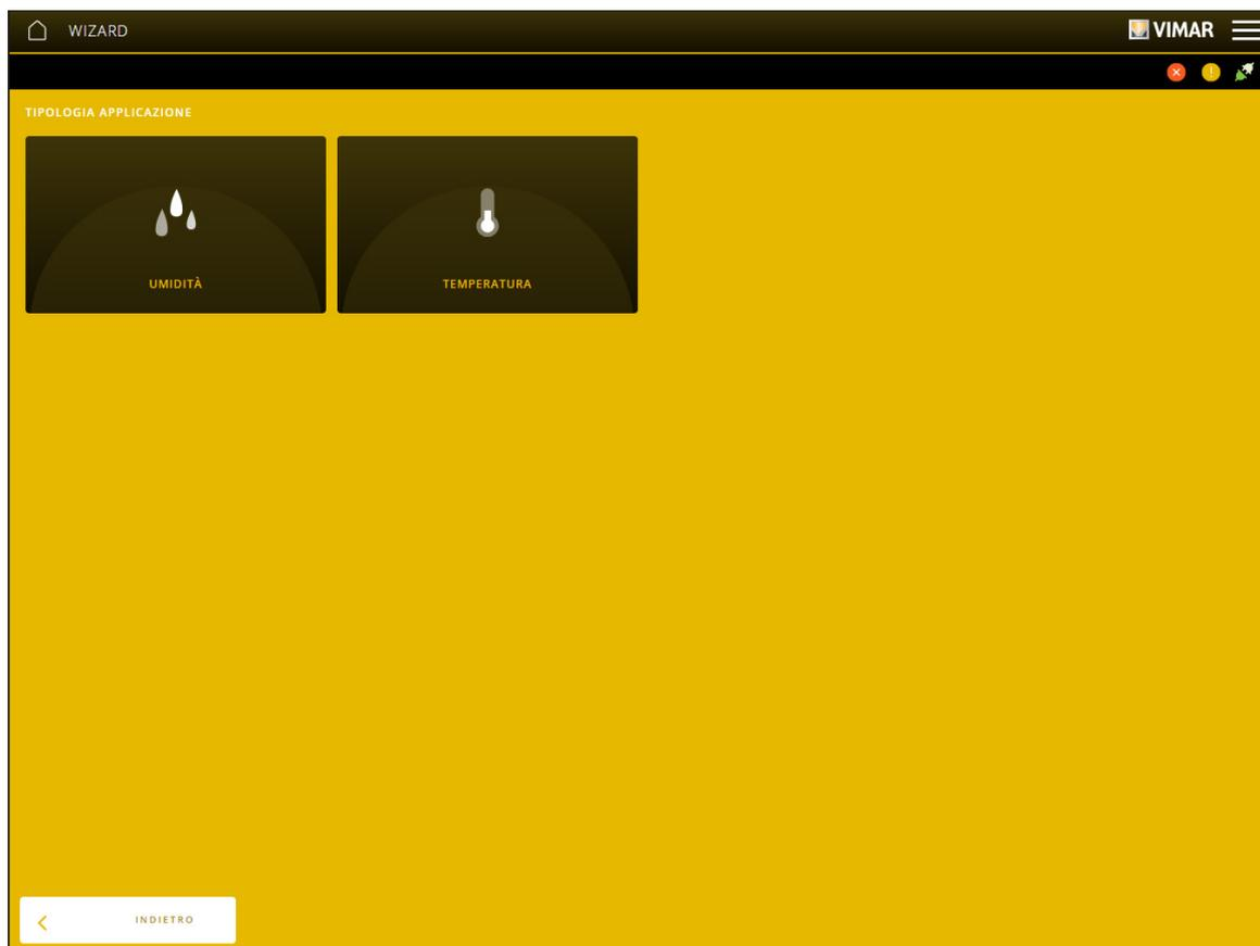
Selección de TEMPERATURA; se muestra la pantalla que permite la selección de la sonda asociada al termostato.
