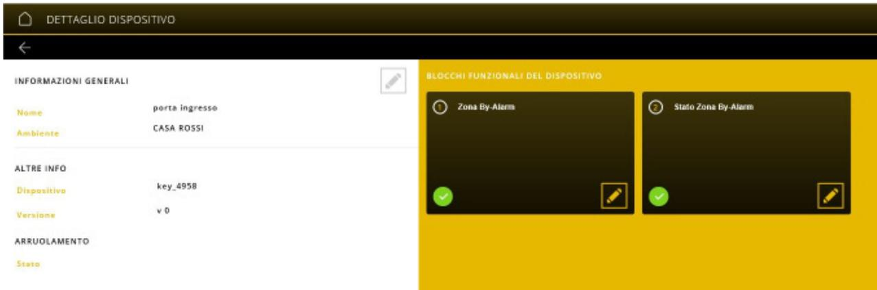
El bloque funcional "Zona By-Alarm" define la detección de presencia mientras que "Estado zona By-Alarm" configura el envío del mensaje de alarma.
