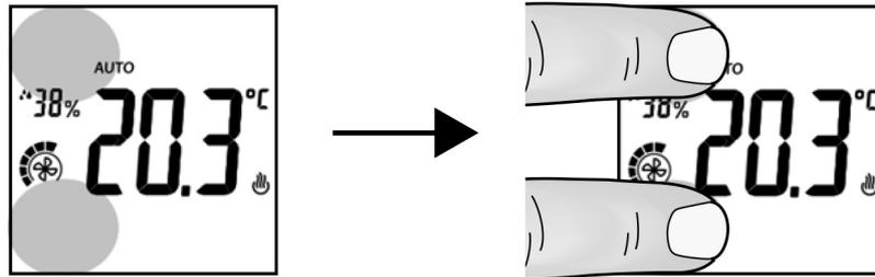
La retroiluminación se vuelve de color rojo y en la pantalla se muestra **CnF** (configuración).
