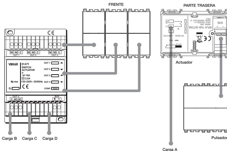
Ningún vínculo relaciona los bloques funcionales de un dispositivo físico. Cuando hay que controlar una carga, es necesario prever un dispositivo (mando o supervisor) y un actuador conectado a la propia carga.
