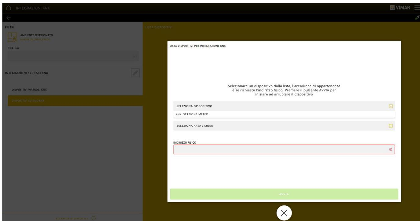
Seleccione la estación meteorológica, introduzca el Área / Línea y, si fuera necesario, introduzca manualmente la dirección física.
