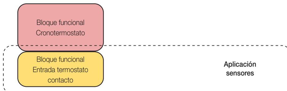
**Nota:** En la aplicación Sensores es posible configurar posteriormente los bloques funcionales ENTRADA CONTACTO BLOQUE POR BUS de otros termostatos para poder desconectarlos desde un único contacto.
