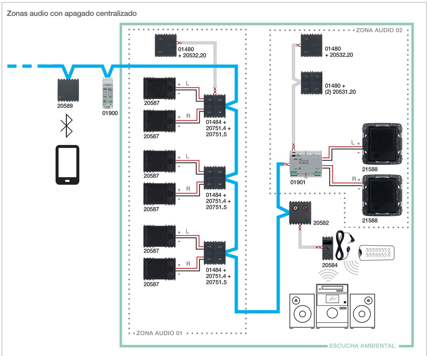
**Dispositivos configurados:** 1 entrada audio 20582, 1 sintonizador FM 01900 y 1 interfaz *Bluetooth technology* 30495-20589 (módulos transmisores), 4 amplificadores audio 30484-01484 y 01901 (módulos receptores) con los mandos correspondientes 20751.4 y 20751.5, 3 mandos By-me 30480-01480 y 1 interfaz IR 20584.
