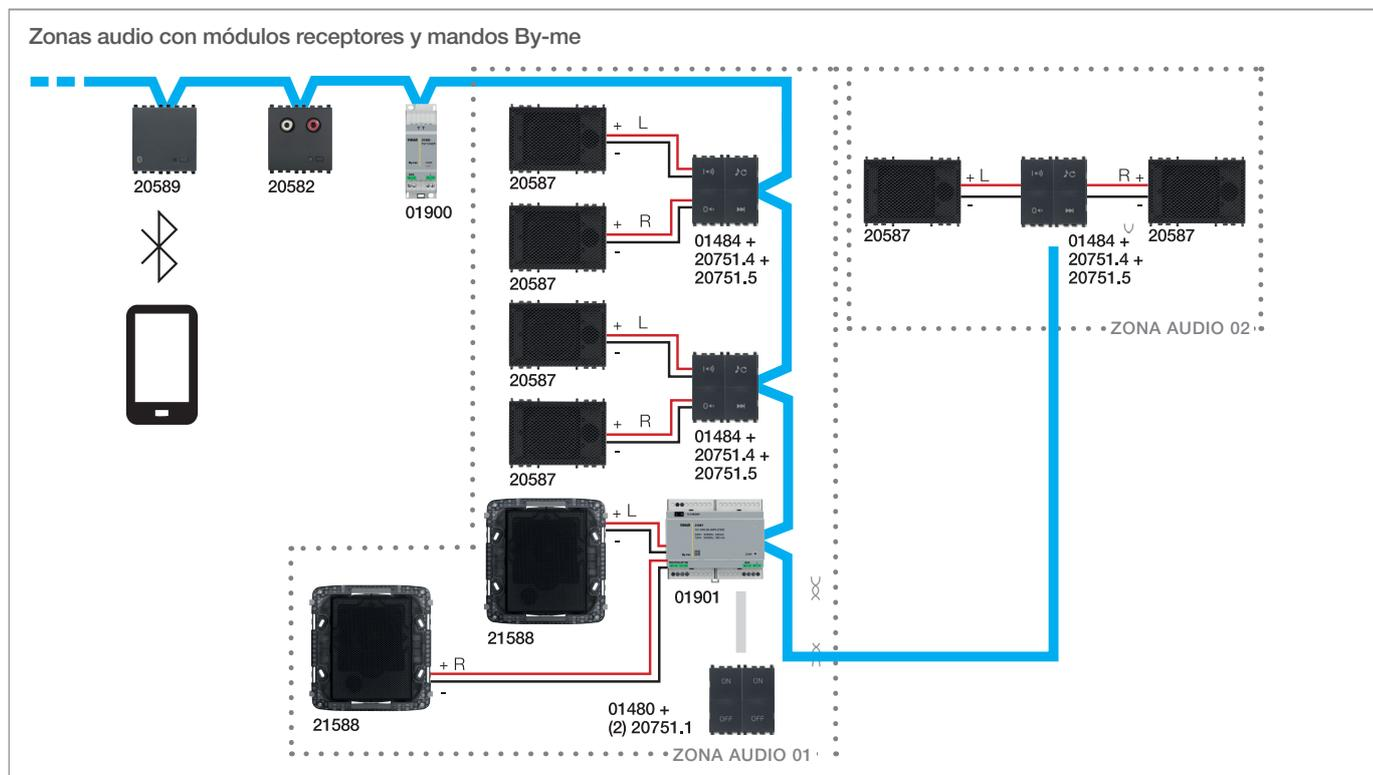
**Dispositivos configurados:** 2 entradas audio 20585 y 20582, 1 sintonizador FM 01900 y 1 interfaz *Bluetooth technology* 30495-20589 (módulos transmisores), 4 amplificadores audio 30484-01484 (módulos receptores) con las teclas correspondientes 20751.4 y 20751.5.
