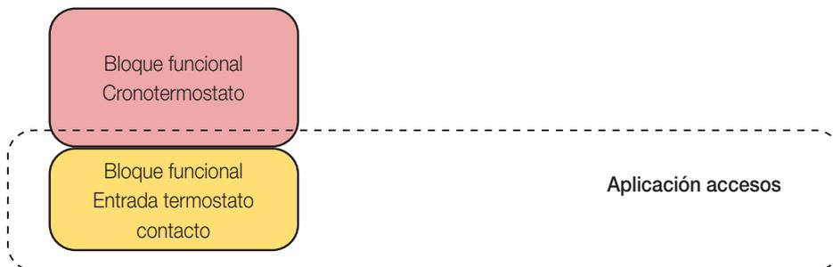
**Nota:** En la aplicación Accesos es posible configurar posteriormente los bloques funcionales ENTRADA CONTACTO VENTANA POR BUS de otros termostatos para poder desconectarlos desde un único contacto de la ventana.
