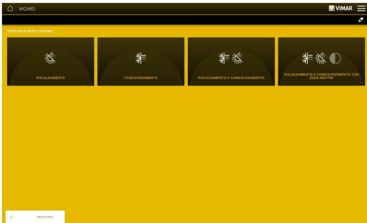
Seleccionar, por ejemplo, "CALEFACCIÓN Y AIRE ACONDICIONADO"; se muestra la pantalla que permite configurar la funcionalidad y los tipos de actuador de las salidas controladas por el termostato.
