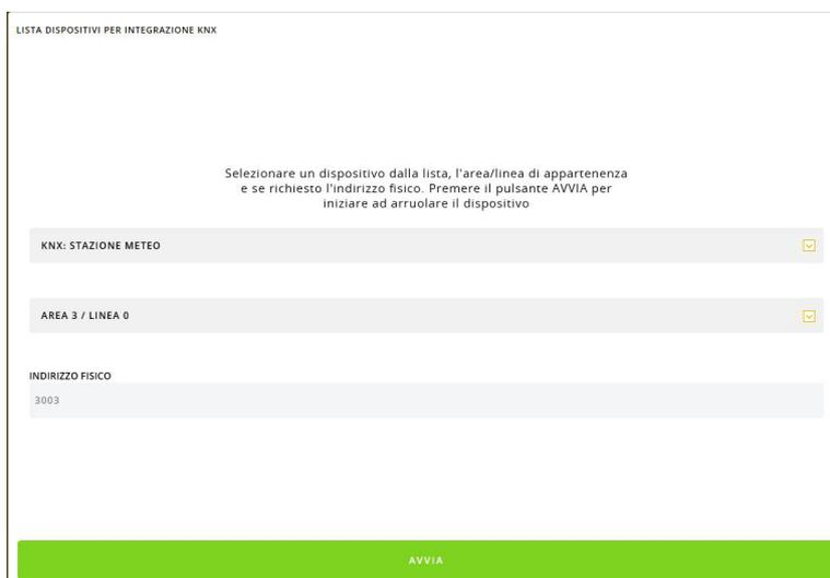
Confirme con "INICIAR" y pulse el botón de configuración de la estación meteorológica.
