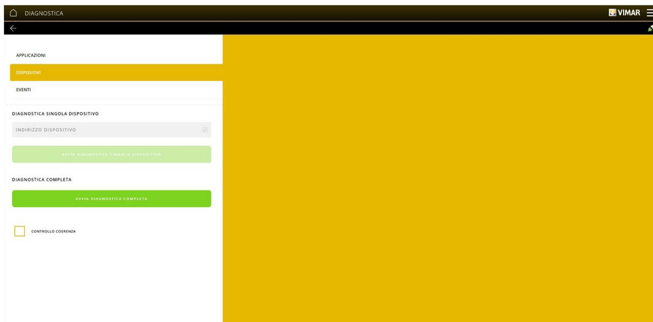
El diagnóstico se realiza solo en los dispositivos By-me (excepto dispositivos KNX, estación meteorológica, etc.) y permite comprobar si los datos presentes en los diferentes dispositivos corresponden a los configurados en las aplicaciones (comparando la configuración de los dispositivos presentes en el bus y el contenido de la base de datos). Al final se muestra el resultado de la operación con todos los resultados y los dispositivos examinados.
