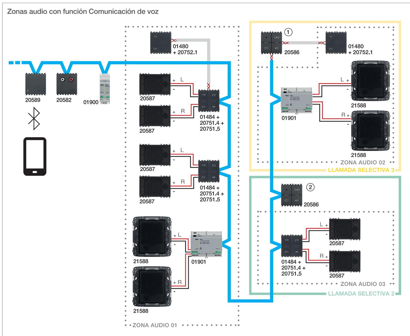
**Dispositivos configurados:** 1 entrada audio 20582, 1 sintonizador FM 01900 y 1 interfaz *Bluetooth technology* 30495-20589 (módulos transmisores), 5 amplificadores audio 30484-01484 y 01901 (módulos receptores) con los mandos correspondientes 20751.4 y 20751.5, 2 mandos By-me 30480-01480 y 2 módulos microfónicos de llamada 20586 (transmisores).
