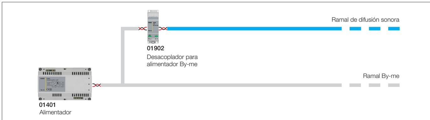
En este caso la separación es solo de cableado y no lógica: los dispositivos de difusión sonora y los dispositivos By-me se configuran en la misma línea.
