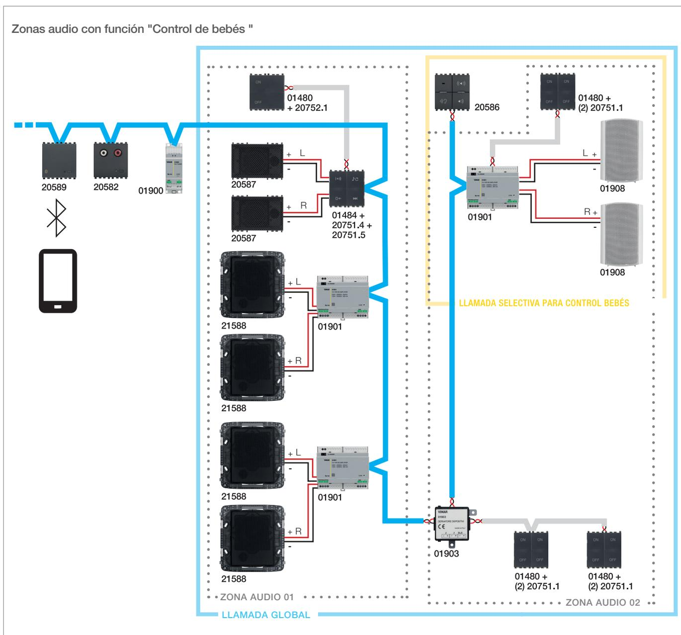
En este ejemplo se muestra una típica instalación en la que una o varias zonas pueden reproducir la fuente de audio procedente de los módulos transmisores.
