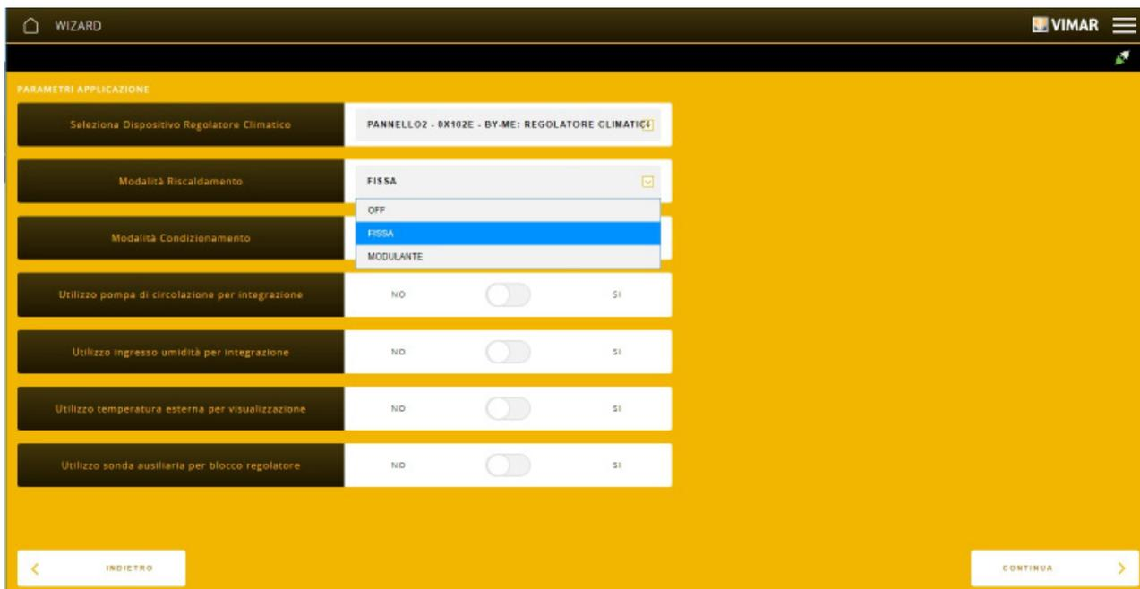
Los ajustes correspondientes a los modos Calefacción y Aire acondicionado se realizan haciendo clic en (por ejemplo, ambos fijos) y se elige qué uso se desea activar (por ejemplo, todos desactivados).
