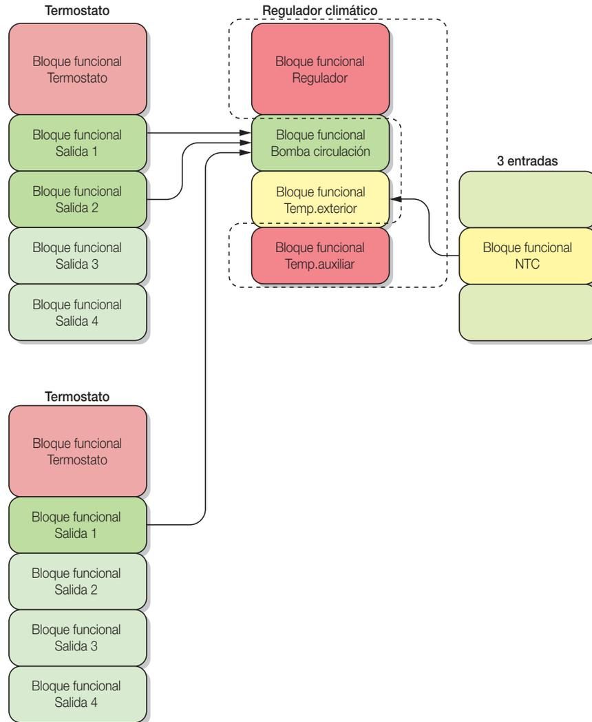
NOTA: Al configurar en aplicaciones vacías un regulador climático estando configurado el bloque funcional Principal, pero no los bloques funcionales Temperatura exterior y Temperatura auxiliar, se solicita si se desea configurar o no dichos bloques; si se elige continuar, la configuración procede automáticamente sin que se muestren otras solicitudes.
