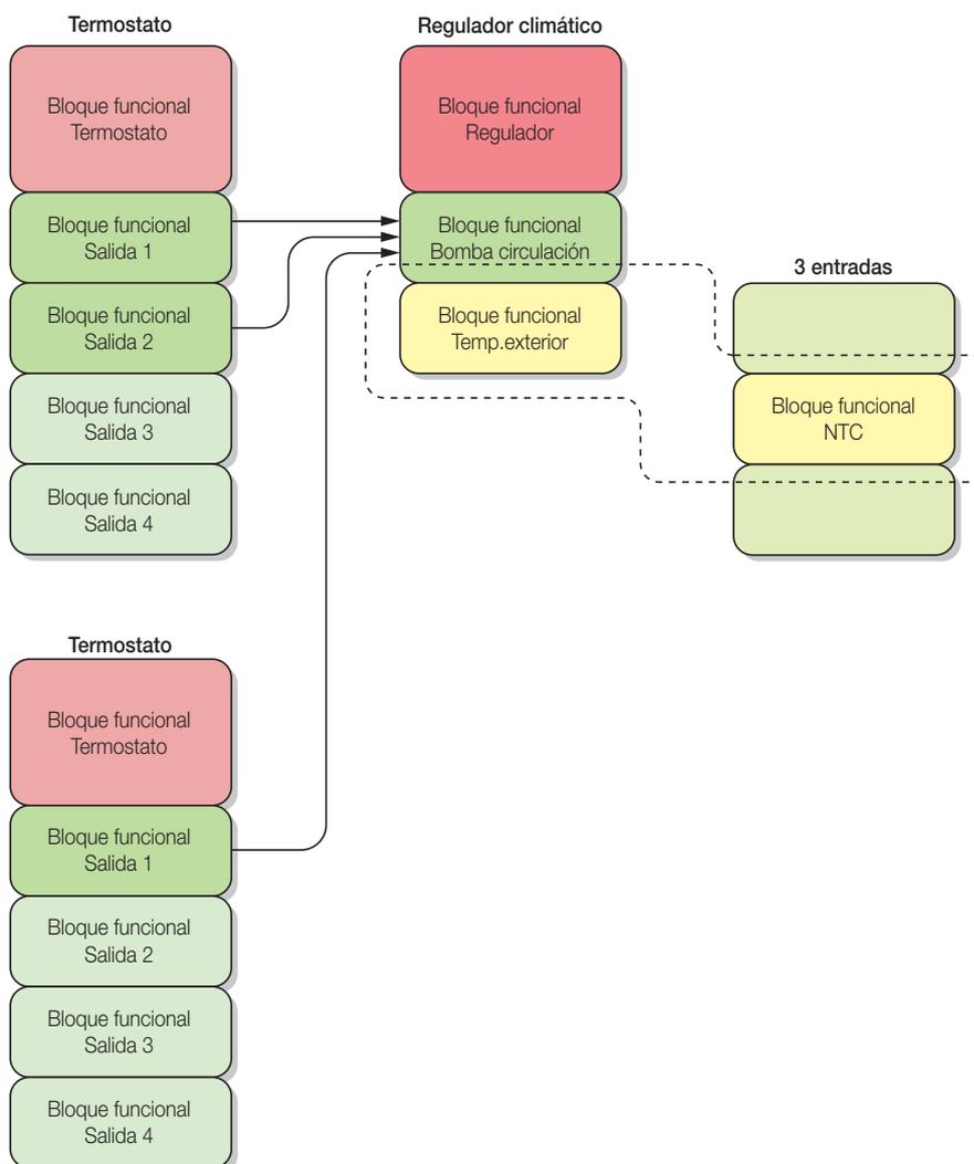
**NOTA:** Cuando se configura el bloque funcional **Temperatura exterior** en una aplicación específica y este bloque es el primero en ser configurado, el regulador (que tiene la sonda físicamente conectada a sus bornes) puede suministrar la temperatura exterior a otros reguladores 01465; para ello es suficiente configurar posteriormente, en la misma aplicación, todos los bloques Temperatura exterior de los demás reguladores para que obtengan la medición.
