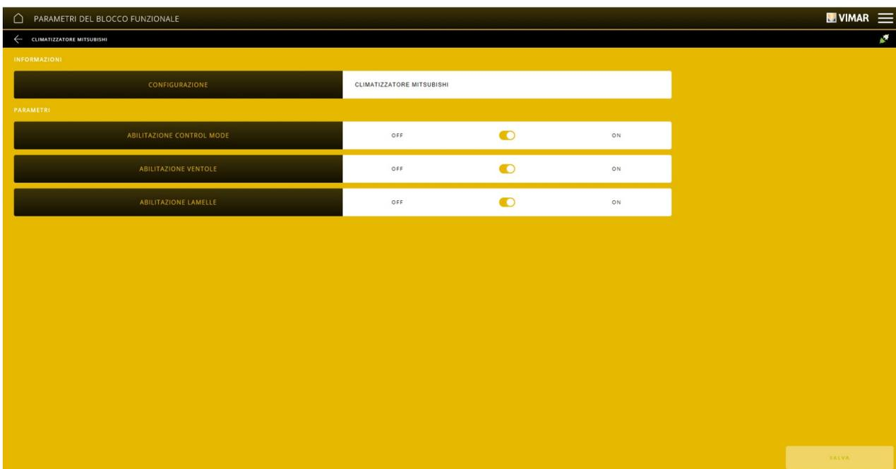
Como se puede observar, es posible elegir si se desea habilitar o no la posibilidad de configurar y ver en la aplicación View y en las pantallas de supervisión el modo de funcionamiento, la velocidad de los ventiladores o la posición de las láminas.
