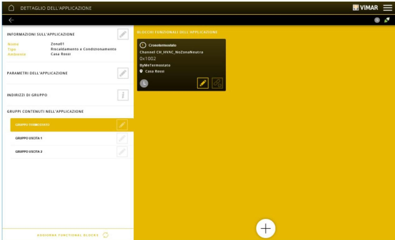
En cada grupo, hay que asociar ahora los bloques funcionales de los actuadores de relé (que controlan la instalación de termostatación) que se desea someter al control del termostato.
