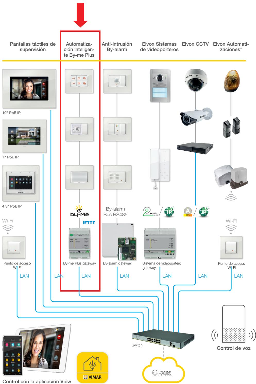
Se recomienda utilizar switches de altas prestaciones que garanticen la fiabilidad de la plataforma basada en IP (por ejemplo, switches Elvox). Evite utilizar los puertos de los routers consumidores, porque no se sabe a priori el tipo de filtrado que se puede realizar en los datos en tránsito.
