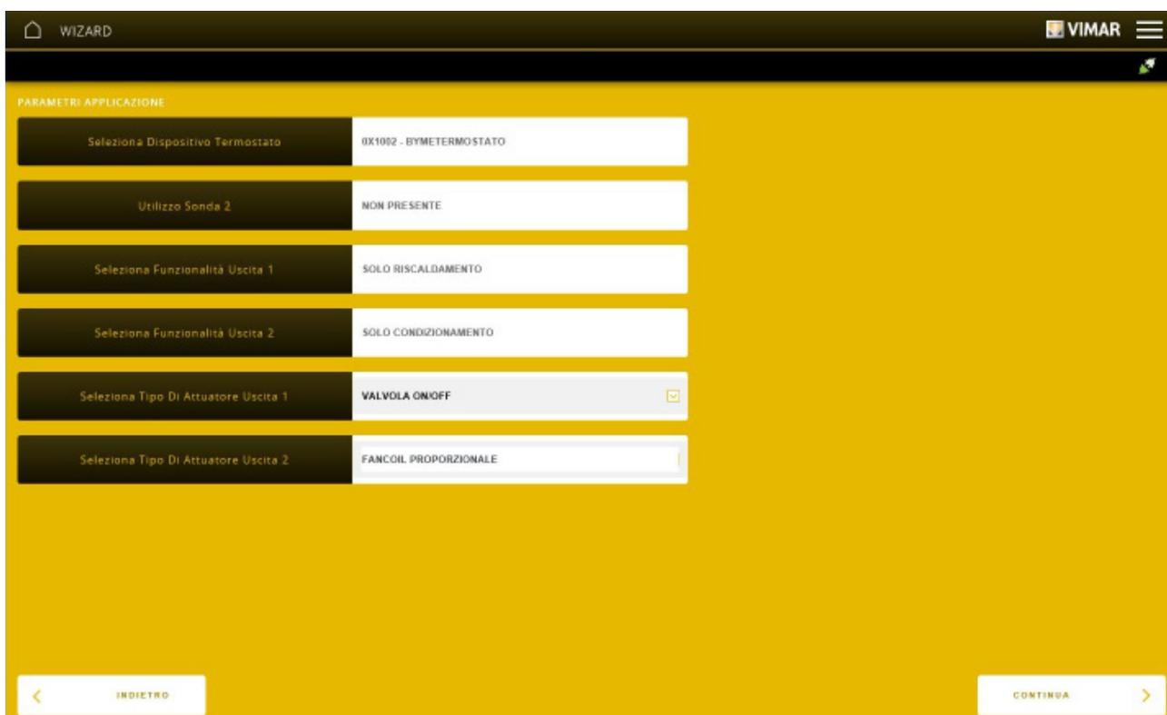
NOTA: Si no se configura "Utilización sonda 2", no se podrá hacerlo más adelante; habrá que volver a configurar el termostato incluyendo también la sonda.
