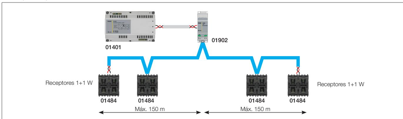
En función del número de transmisores y receptores (y su tipo) puede calcularse la absorción del sistema y, por consiguiente, el número de alimentadores necesarios que, en todos caso, pueden ser 2 como máximo. Si se desean instalar numerosos receptores 1+1 W (art. 30484-01484), se recomienda utilizar los alimentadores auxiliares 20580-19580-14580.
