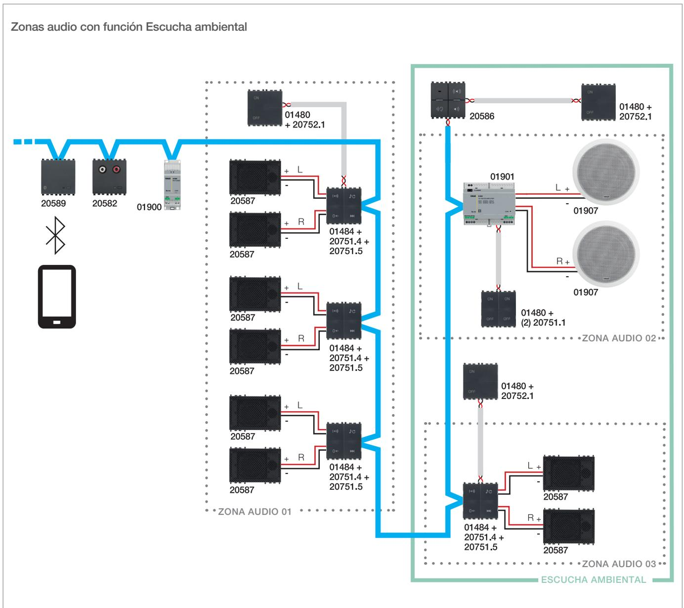
**Dispositivos configurados:** 1 entrada audio 20582, 1 sintonizador FM 01900 y 1 interfaz *Bluetooth technology* 30495-20589 (módulos transmisores), 5 amplificadores audio 30484-01484 y 01901 (módulos receptores) con los mandos correspondientes 20751.4 y 20751.5, 3 mandos By-me 30480-01480 y 1 módulo microfónico de llamada 20586 (transmisor).
