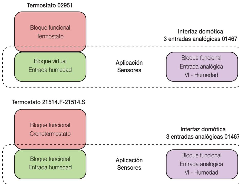
Nota: En la misma aplicación para sensores se pueden introducir varios bloques de entrada Humedad de diferentes termostatos/reguladores climáticos.
