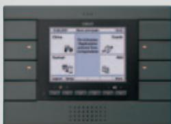
**Centrale By-me.** È il cuore del sistema. Da qui si pilota tutto: automazioni, antintrusione, clima, consumi energetici, videocitofono. In modo semplice, intuitivo, immediato e attraverso interfacce dedicate, è possibile estendere l'impianto di automazione e antintrusione in radiofrequenza
