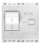
20411.16.B C 16, I_{\Delta n} 10 mA, Ausschaltvermögen 3000 A - 2 Module
