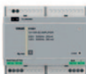
01901 Stereoverstärker mit 2 Ausgängen für Lautsprecher 8 Ω 10+10 W RMS, Spannungsversorgung 110-230 V~ 50/60 Hz, eingebauter Leitungsabschluss
