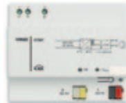
01501 Netzgerät mit Bus-Ausgang 30 V d.c. 640 mA, Hilfsausgang 30 V d.c., Spannungsversorgung 230 V~ 50-60 Hz, mit Entkopplung-Spule, KNX-Standard
