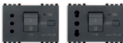
Δ 20281 10 A P11 250 V~, 1P+N C 10 - 3 Module 20283 Bpresa 16 A P17/11 250 V~, 1P+N C 16 - 3 Module
