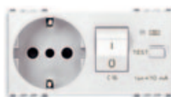
20286.B 16 A P30 250 V~, 1P+N C 16 - 4 Module
