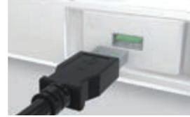
Presa USB (1,5 A) per la ricarica di dispositivi elettronici.
