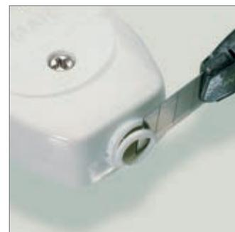
Codulo integrato sezionabile con cutter (diametro massimo del foro 10 mm per presa 10 A, o 11 mm per presa 16 A).
