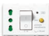
14283 Bpresa 16 A P17/11 250 V~, 1P+N C 16 - 3 modules. Depth: 38,7 mm
