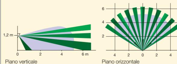
2. Installazione con supporto art. 00802 a 2,1 m di altezza e rivelatore orientato all'angolo di elevazione minore (installazione non certificata IMQ-sistemi di sicurezza).
