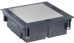
V54420.01 Torretta a scomparsa da pavimento da 20 moduli con coperchio inox per apparecchi Eikon, Arké e Plana per installazione su pavimento flottante. Fornita con 4 supporti da 5 moduli. Installazione su massetto con apposita scatola V54920
