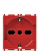
14210.AB.R Presa SICURY 2P+T 16 A 250 V~ universale, rosso - 2 moduli. Prof.tà: 25 mm
