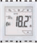
02951.B Termostato touch screen (riscaldamento e condizionamento), gestione impianti a 2 e 4 tubi, comando fan-coil a 3 velocità e proporzionale, dispositivo di controllo della temperatura di classe I (contributo 1%) in modalità ON/OFF, di classe IV (contributo 2%) in modalità PID, 1 ingresso per sensore NTC di temperatura filare o da incasso, retroilluminazione a led RGB, interfacciabile con attuatore con uscite analogiche proporzionali 01466 per realizzare un termostato d'ambiente modulante di classe V (contributo 3%) - 2 moduli
