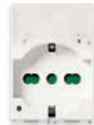
14210.C.AB Presa SICURY 2P+T 16 A 250 V~ universale con coperchio - 2 moduli. Prof.tà: 25 mm
