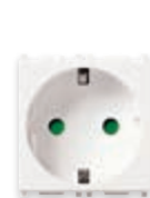
14208.AB Presa SICURY 2P+T 16 A 250 V~, standard tedesco - 2 moduli. Prof.tà: 28,4 mm
