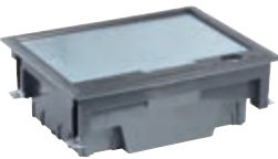
V54412 Torretta a scomparsa da pavimento con coperchio cavo per apparecchi Eikon, Arké e Plana per installazione su pavimento flottante. Fornita con 2 supporti da 6 moduli. Installazione su massetto con apposita scatola V54912
