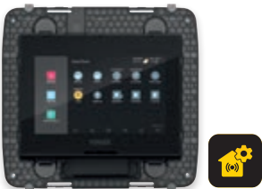
01420*** Touch screen a colori 4,3" IP, utilizzabile come supervisore domotico, posto interno videocitofonico IP/Due Fili Plus, gestore telecamere IP e sistemi TVCC, PoE o 12-30 Vdc, completo di supporto per installazione da incasso in scatole 8 moduli (4+4), completare con placche Eikon, Arké o Plana, nero
