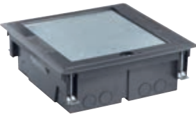
V54420 Torretta a scomparsa da pavimento da 20 moduli con coperchio cavo per apparecchi Eikon, Arké e Plana per installazione su pavimento flottante. Fornita con 4 supporti da 5 moduli. Installazione su massetto con apposita scatola V54920
