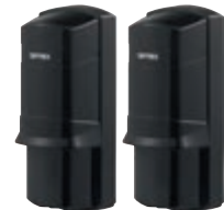
01743 Kit barriera composta da coppia TX/RX a infra- rosso attivo (AIR) con portata 60 metri per esterni, con 4 canali selezionabili per la realizzazione di una barriera a colonna composta da più rilevatori sovrapposti, IP65, 1 uscita a relè NO/NC 28 Vdc 0.2A per allarme, 1 uscita a relè NC 28 Vdc 0.2A per disqualifica ambientale (in caso di nebbia, pioggia, neve), alimentazione 10,5-28 Vdc con 48 mA 12V installazione a parete, a palo, a colonna da esterno
