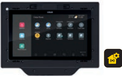
01425*** Touch screen a colori 10" IP, utilizzabile come supervisore domotico, posto interno videocitofonico IP/Due Fili Plus, gestore telecamere IP e sistemi TVCC, PoE o 12-30 Vdc, installazione a parete con staffa su scatola rotonda, rettangolare 3 moduli (orizzontale e verticale), 8 moduli (4+4) e quadrata BS, nero
