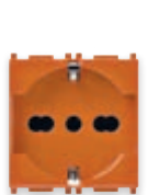
14210.AB.A Presa SICURY 2P+T 16 A 250 V~ universale, arancione - 2 moduli. Prof.tà: 25 mm
