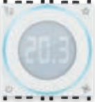
02971.B Termostato per domotica a rotella per controllo della temperatura ambiente (riscaldamento e condizionamento), gestione impianti a 2 e 4 tubi, comando fan-coil a 3 velocità e proporzionale, dispositivo di controllo della temperatura di classe I (contributo 1%) in modalità ON/OFF, di classe IV (contributo 2%) in modalità PID, interfacciabile con attuatore con uscite analogiche proporzionali 01466.1 per realizzare un termostato d'ambiente modulante di classe V (contributo 3%), 1 ingresso per sensore elettronico di temperatura 20432, 19432 o 14432 o sensore di temperatura filare 02965.1, retroilluminazione a led bianca
