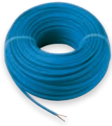
01840.E.B Cavo per diffusione sonora sistema Bus By-me, 2x0,50 mm², con guaina in LSZH, Classe CPR Eca, idoneo per installazione con cavi energia di I Categoria (U0 = 400 V), blu - 100 m
