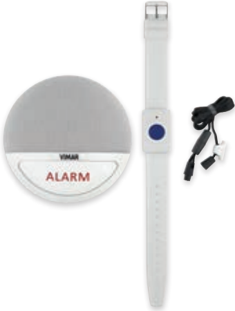
03890 Dispositivo di telesoccorso per chiamata via rete cellulare di numeri predefiniti. La chiamata vivavoce viene avviata premendo il pulsante "Alarm" o tramite il pulsante dell'accessorio bracciale/pendaglio in dotazione o tramite un altro dispositivo collegato all'interfaccia 03895. Il dispositivo consente anche la ricezione di chiamate esterne con risposta automatica
