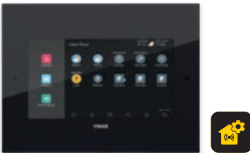
01422*** Touch screen a colori 7" IP, utilizzabile come supervisore domotico, posto interno videocitofonico IP/Due Fili Plus, gestore telecamere IP e sistemi TVCC, PoE o 12-30 Vdc, installazione a parete con staffa su scatola rotonda, rettangolare 3 moduli (orizzontale e verticale), 8 moduli (4+4) e quadrata BS, nero
