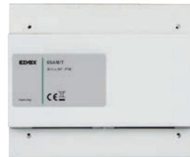
Il selettore video per 4 telecamere 69AM/T permette il collegamento all'impianto Due Fili Plus di 4 telecamere con uscita CVBS. La selezione delle telecamere è ciclica per mezzo del pulsante serratura o di un pulsante dedicato dopo la fase di autoaccensione. Al selettore si possono collegare anche le due funzioni ausiliarie F1 e F2.
