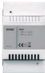
Il modulo relè 69PH, è un dispositivo programmabile dotato di due relè con contatto in scambio e può essere installato sia sul BUS Verticale che sul BUS Orizzontale. Se installato sul BUS Verticale, può essere programmato anche manualmente con le stesse modalità del modulo relè 69RH, se invece è installato sul BUS Orizzontale può essere programmato esclusivamente tramite il software SaveProg.
