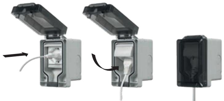
La **posizione orientabile del corpo presa** è la caratteristica fondamentale di questi prodotti, sia quello già assemblato con la presa universale che quello vuoto. Un semplice movimento di rotazione a 70° consente al coperchio di chiudersi ermeticamente, qualunque sia la spina collegata, sia assiale che salvaspazio. Viene così garantita al contenitore la massima tenuta stagna e il grado di protezione IP66.
