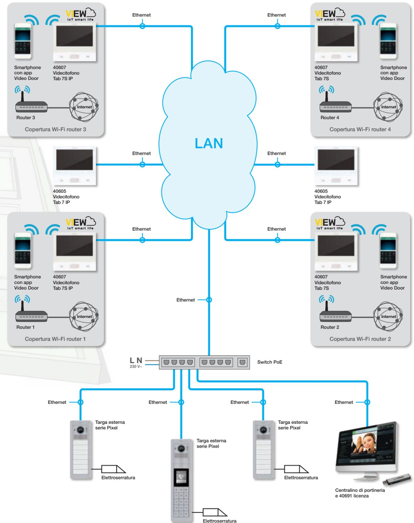
**Nota:** esempio di installazione tipo su rete LAN dedicata alla videocitofonia. Il cablaggio strutturato passivo e i componenti attivi possono variare a seconda della tipologia della rete definita per la specifica applicazione.
