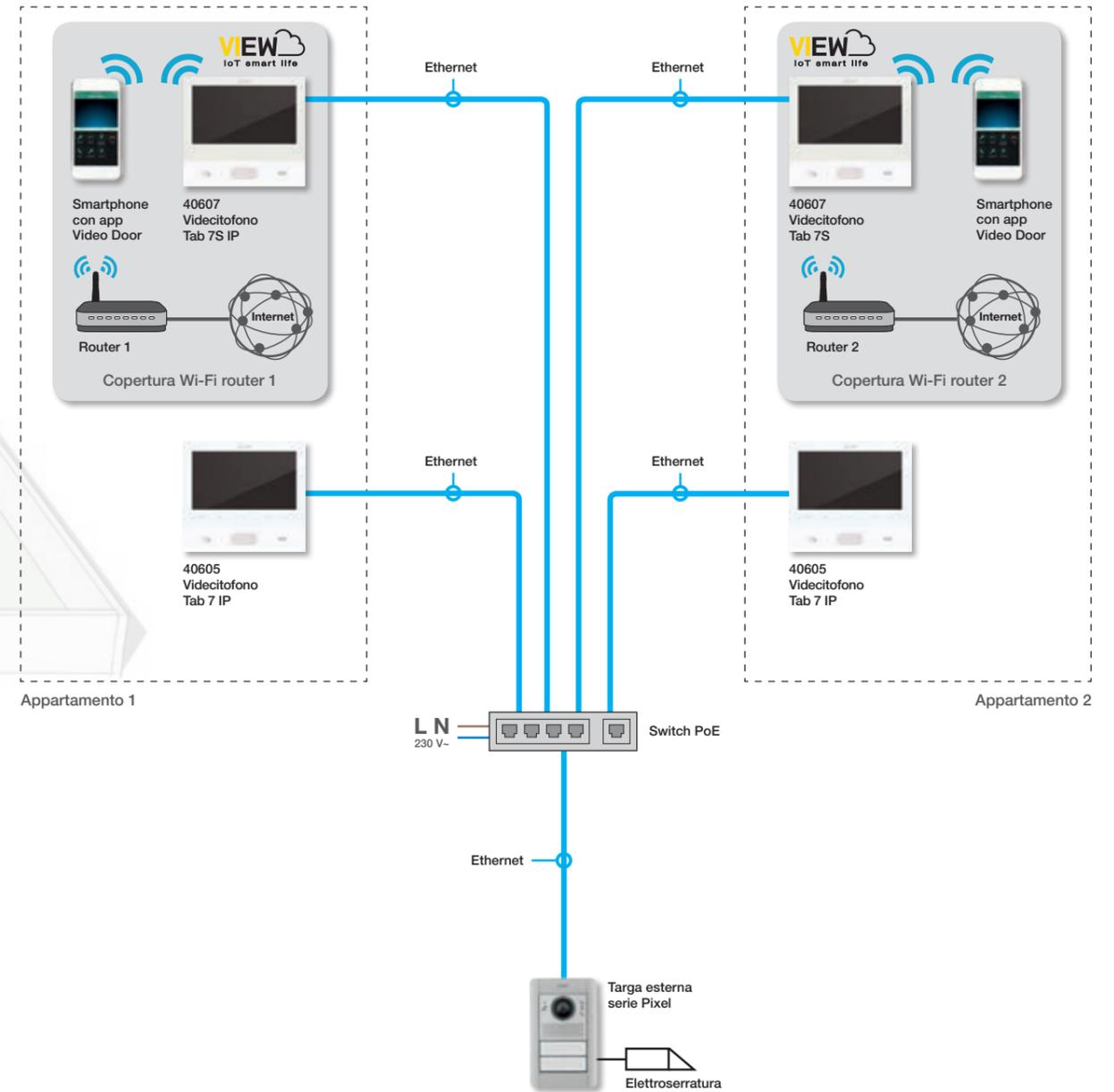
**Nota:** esempio di installazione tipo su rete LAN dedicata alla videocitofonia. Il cablaggio strutturato passivo e i componenti attivi possono variare a seconda della tipologia della rete definita per la specifica applicazione.
