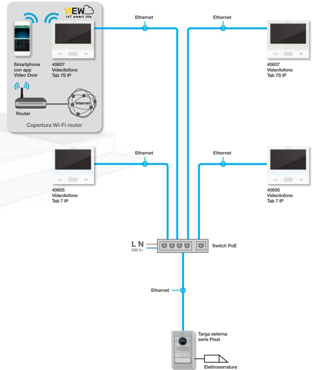
**Nota:** esempio di installazione tipo su rete LAN dedicata alla videocitofonia. Il cablaggio strutturato passivo e i componenti attivi possono variare a seconda della tipologia della rete definita per la specifica applicazione.
