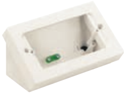
30784.B Geneigte Tischdose verstellbarer Höhe für die Installation von 4 Modulen. In der niedrigen Version können Schaltelemente mit max. 32 mm Tiefe installiert werden. Durch Drehen des Deckels steigt die maximale Tiefe auf 44 mm. Die Steckdose mit USB, 30210.USB kann nicht installiert werden. Zur Ergänzung mit Halterung und Abdeckrahmen.
