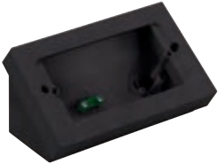
30784.G Geneigte Tischdose verstellbarer Höhe für die Installation von 4 Modulen. In der niedrigen Version können Schaltelemente mit max. 32 mm Tiefe installiert werden. Durch Drehen des Deckels steigt die maximale Tiefe auf 44 mm. Die Steckdose mit USB, 30210.USB kann nicht installiert werden. Zur Ergänzung mit Halterung und Abdeckrahmen.
