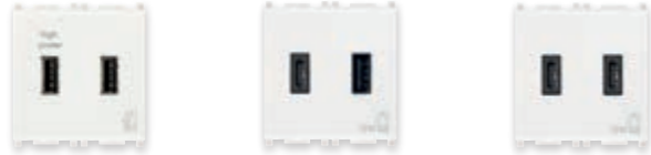
14295 5 V 10,5 W, 2 USB A pour un total de 2,1 A, 120-230 V~ 50/60 Hz - 2 modules. Prof. : 36 mm 14295.AC 5 V 15 W, USB A+C pour un total de 3 A, 120-240 V~ 50/60 Hz - 2 modules. Prof. : 29 mm 14295.CC 5 V 15 W, 2 USB C pour un total de 3 A, 120-240 V~ 50/60 Hz - 2 modules. Prof. : 29 mm
