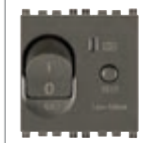
19411.06.M C 6, I Δn 10 mA pouvoir de coupure 1500 A - 2 modules. Profondeur: 39 mm
