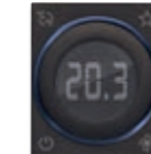
30471.G Thermostat à molette (chauffage et climatisation), pour installations à 2/4 tubes, commande ventilateur à 3 vitesses et proportionnelle, contrôle ON/OFF (classe I, contribution 1%), PID (classe IV, contribution 2%), interfaçable avec actuateur 01466.1 pour thermostat d'ambiance modulé (classe V, contribution 3%), 1 entrée pour capteur de température filaire 02965.1, noir - 2 modules. Prof. : 31,8 mm À compléter avec les plaques Linea.
