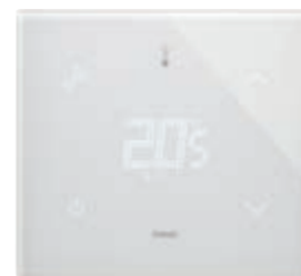
21814.H.70 Thermostat à écran tactile (chauffage et climatisation), commande MAKE UP ROOM et DO NOT DISTURB, dispositif de contrôle de la température appartenant à la classe I (contribution 1%) en modalité ON/OFF, à la classe IV (contribution 2%) en modalité PID, interfaçable avec Actionneur à sorties analogiques proportionnelles 01466.1 pour réaliser un thermostat d'ambiance modulé classe V (contribution 3%), 1 entrée pour capteur électronique de température 20432, 19432 ou 14432 ou capteur de température filaire 02965.1, 1 entrée numérique programmable, rétroéclairage à LEDs RGB, blanc diamant - 2 modules. Profondeur: 30,2 mm
