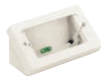
30784.B Boîte inclinée de table, hauteur variable, pour l'installation de 4 modules. La version surbaissée permet d'installer des prises d'une profondeur maximale de 32 mm ; en tournant le couvercle, la profondeur maximale passe à 44 mm. La prise de courant avec USB, 30210.USB n'est pas compatible.
