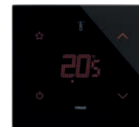
21514.S.76 Thermostat à écran tactile (chauffage et climatisation), commande STAR configu- rable, dispositif de contrôle de la température appartenant à la classe I (contribution 1%) en modalité ON/OFF, à la classe IV (contribution 2%) en modalité PID, interfaçable avec Actionneur à sorties analogiques proportionnelles 01466.1 pour réaliser un thermostat d'ambiance modulé classe V (contribution 3%), 1 entrée pour capteur électronique de température 20432, 19432 ou 14432 ou capteur de température filaire 02965.1, 1 entrée numérique programmable, rétroéclairage à LEDs RGB, noir diamant - 2 modules. Profondeur: 30,2 mm
