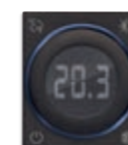
30440.G Thermostat à molette avec sortie à relais 5(2) A 240 V~, chauffage et climatisation en mode ON/OFF, dispositif de contrôle de la température classe I (contribution 1%), rétroéclairage à led blanche avec réglage de l'intensité, 100-240 V 50/60 Hz - 2 modules. Prof. : 31,8 mm
