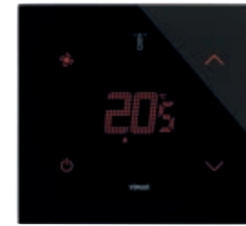
21814.F.76 Thermostat à écran tactile (chauffage et climatisation), commande VENTIL-CONVECTEUR à 3 vitesses et proportionnelle, dispositif de contrôle de la température appartenant à la classe I (contribution 1%) en modalité ON/OFF, à la classe IV (contribution 2%) en modalité PID, interfaçable avec Actionneur à sorties analogiques proportionnelles 01466.1 pour réaliser un thermostat d'ambiance modulé classe V (contribution 3%), 1 entrée pour capteur électronique de température 20432, 19432 ou 14432 ou capteur de température filaire 02965.1, 1 entrée numérique programmable, rétroéclairage à LEDs RGB, noir diamant - 2 modules. Profondeur: 30,2 mm
