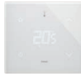
21814.S.70 Thermostat à écran tactile (chauffage et climatisation), commande STAR configurable, dispositif de contrôle de la température appartenant à la classe I (contribution 1%) en modalité ON/OFF, à la classe IV (contribution 2%) en modalité PID, interfaçable avec Actionneur à sorties analogiques proportionnelles 01466.1 pour réaliser un thermostat d'ambiance modulé classe V (contribution 3%), 1 entrée pour capteur électronique de température 20432, 19432 ou 14432 ou capteur de température filaire 02965.1, 1 entrée numérique programmable, rétroéclairage à LEDs RGB, blanc diamant - 2 modules. Profondeur: 30,2 mm
