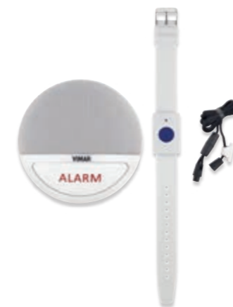
03890 Dispositif mains libres de télésecours pour appel via réseau mobile LTE de numéros prédéfinis. L'appel mains libres se déclenche en appuyant sur la touche « Alarm » ou sur le bouton de l'accessoire bracelet/pendentif. Le dispositif permet également de recevoir des appels extérieurs avec réponse automatique.
