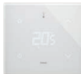
21514.S.70 Thermostat à écran tactile (chauffage et climatisation), commande STAR configu- rable, dispositif de contrôle de la température appartenant à la classe I (contribution 1%) en modalité ON/OFF, à la classe IV (contribution 2%) en modalité PID, interfaçable avec Actionneur à sorties analogiques proportionnelles 01466.1 pour réaliser un thermostat d'ambiance modulé classe V (contribution 3%), 1 entrée pour capteur électronique de température 20432, 19432 ou 14432 ou capteur de température filaire 02965.1, 1 entrée numérique programmable, rétroéclairage à LEDs RGB, blanc diamant - 2 modules. Profondeur: 30,2 mm
