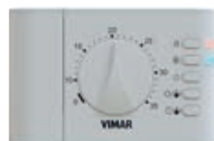
02900.1 Thermostat électronique pour le contrôle ON/OFF de la température ambiante (chauffage, climatisation), dispositif de contrôle de la température classe I (contribution 1%), sortie à relais avec contact inverseur 5(2) A 240 V~, alimentation par batteries AA LR6 1,5 V 1,5 V (non livrées), installation en saillie, blanc
