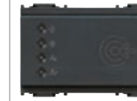
16927 Lecteur de cartes à transpondeur pour extérieur pièce, standard KNX, 2 sorties à relais NO 4 A 24 V~, 2 entrées, 12-24 V~ 50-60 Hz et 12-24 Vcc (TBTS), gris - 3 modules. Livré en série sans carte à transpondeur. Prof. : 36,5 mm
