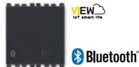
19590 1 Amplificateur stéréo 4+4 W, 2 sorties pour diffuseurs sonores 8 Ω avec récepteur incorporé Bluetooth® wireless technology , 1 LINE IN, alimentation 12 Vdc - 2 modules. Profondeur: 36,7 mm
