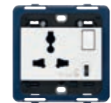
■ 19266.C.B SICURY 2P+T 13 A 250 V~ multistandard, avec interrupteur 2P et 1 USB-C. Profondeur: 22,8 mm
