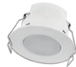
▲01527.2 Détecteur avec capteur de présence infrarouge à 360° pour allumage ON/OFF et réglage constant de l'éclairage, du chauffage, de la climatisation, de la ventilation en fonction de la luminosité et/ou du mouvement, champ de luminosité réglable 1- 1000 Lux, installation au plafond. Dim. 80x80x45 mm
