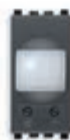
20181 Allumage d'éclairage, sortie relais NO 6 A 230 V-, 50/60 Hz 20181.120 Comme ci-dessus, 120 V-. Prof.: 37 mm
