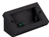
30784.G Boîte inclinée de table, hauteur variable, pour l'installation de 4 modules. La version surbaissée permet d'installer des prises d'une profondeur maximale de 32 mm ; en tournant le couvercle, la profondeur maximale passe à 44 mm. La prise de courant avec USB, 30210.USB n'est pas compatible.
