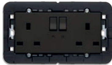
▲ 30222.G 4 SICURY 2P+T 13 A, 2 interrupteurs 2P, avec support. Prof. : 23,1 mm ▲ 30222.LG 4 Idem ci-dessus, avec témoin lumineux
