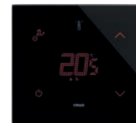
21514.H.76 Thermostat à écran tactile (chauffage et climatisation), commande MAKE UP ROOM et DO NOT DISTURB, dispositif de contrôle de la température appartenant à la classe I (contribution 1%) en modalité ON/OFF, à la classe IV (contribution 2%) en modalité PID, interfaçable avec Actionneur à sorties analogiques proportionnel- les 01466.1 pour réaliser un thermostat d'ambiance modulé classe V (contribution 3%), 1 entrée pour capteur électronique de température 20432, 19432 ou 14432 ou capteur de température filaire 02965.1, 1 entrée numérique programmable, rétroéclairage à LEDs RGB, noir diamant - 2 modules. Profondeur: 30,2 mm
