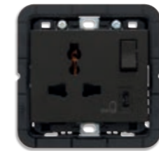
▲ 30266.CG SICURY 2P+T 13 A, interrupteur 2P, 1 USB C 12 W, avec support. Prof. : 27,7 mm
