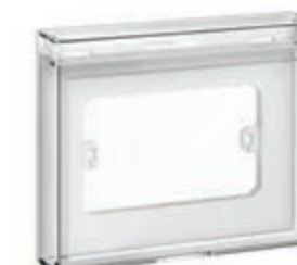
14923 Calotte de protection IP44 avec volet trans- parent, 3 modules, pour installation sur boîte d'encastrement 3 modules. La partie centrale de la membrane permet d'actionner les com- mandes présentes dans la calotte fermée. Compatible avec Eikon Exé, Linea, Arké, Plana et avec les principales séries résiden- tielles présentes dans le commerce
