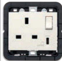
▲ 30223.CB SICURY 2P+T 13 A, interrupteur 2P, 1 USB C 12 W, avec support. Prof. : 27,7 mm
