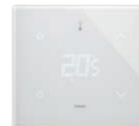
21514.S.70 Thermostat à écran tactile (chauffage et climatisation), commande STAR configurable, contrôle ON/OFF (classe I, contribution 1%), PWM, PID (classe IV, contribution 2%), interfaçable avec actuateur 01466.1 pour thermostat d'ambiance modulé (classe V, contribution 3%), 1 entrée pour capteur 20432, 19432 ou 14432 ou capteur filaire 02965.1, 1 entrée numérique programmable, rétroéclairage à leds RGB, blanc diamant - 2 modules. Prof. : 30,2 mm
