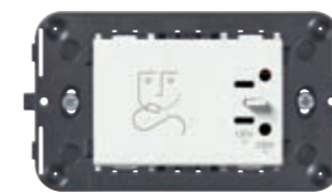
09290 Prise à rasoir avec transformateur d'isolation 20 VA, alimentation 230 V~ 50-60 Hz, sorties 230 V~ et 120 V~ - 3 modules. Profondeur: 42 mm
