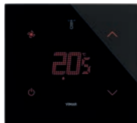
21514.F.76 Thermostat à écran tactile (chauffage et climatisation), commande VENTIL-CON- VECTEUR à 3 vitesses et proportionnelle, dispositif de contrôle de la température appartenant à la classe I (contribution 1%) en modalité ON/OFF, à la classe IV (con- tribution 2%) en modalité PID, interfaçable avec Actionneur à sorties analogiques proportionnelles 01466.1 pour réaliser un thermostat d'ambiance modulé classe V (contribution 3%), 1 entrée pour capteur électronique de température 20432, 19432 ou 14432 ou capteur de température filaire 02965.1, 1 entrée numérique programmable, rétroéclairage à LEDs RGB, noir diamant - 2 modules. Profondeur: 30,2 mm
