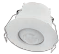
▲01529.2 Détecteur avec capteur de présence infrarouge à 360° pour allumage ON/OFF de l'éclairage en fonction de la luminosité et/ou du mouvement, champ de luminosité réglable 1-1000Lux, installation au plafond. Dim. 91x91x45 mm
