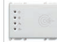
14457 Lecteur de cartes à transpondeur pour extérieur pièce, standard KNX, 2 sorties à relais NO 4 A 24 V~, 2 entrées, 12-24 V~ 50-60 Hz et 12-24 Vcc (TBTS), blanc 3 modules. Livré en série sans carte à transpondeur. Prof. : 36 mm
