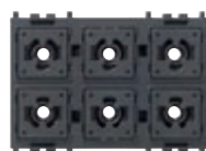
02687.AX 6 boutons 1P NO 24 Vdc 50 mA max., éclairables - 3 modules. Prof.: 16,5 mm À compléter avec les boutons 22751.RN...
