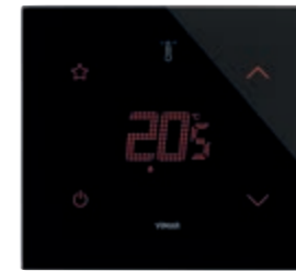
21814.S.76 Thermostat à écran tactile (chauffage et climatisation), commande STAR configurable, dispositif de contrôle de la température appartenant à la classe I (contribution 1%) en modalité ON/OFF, à la classe IV (contribution 2%) en modalité PID, interfaçable avec Actionneur à sorties analogiques proportionnelles 01466.1 pour réaliser un thermostat d'ambiance modulé classe V (contribution 3%), 1 entrée pour capteur électronique de température 20432, 19432 ou 14432 ou capteur de température filaire 02965.1, 1 entrée numérique programmable, rétroéclairage à LEDs RGB, noir diamant - 2 modules. Profondeur: 30,2 mm
