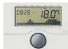
01910 Chronothermostat électronique de contrôle ON/OFF de la température ambiante (chauffage et climatisation), programmation quotidienne/hebdomadaire, dispositif de contrôle de la température classe I (contribution 1%), sortie à relais avec contact inverseur 5(2) A 250 V~, alimentation par piles stylo AA LR6 1,5 V (non livrées), installation en saillie, blanc
