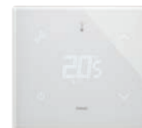
21514.H.70 Thermostat à écran tactile (chauffage et climatisation), commande MAKE UP ROOM et DO NOT DISTURB, contrôle ON/OFF (classe I, contribution 1%), PWM, PID (classe IV, contribution 2%), interfaçable avec actuateur 01466.1 pour thermostat d'ambiance modulé (classe V, contribution 3%), 1 entrée pour capteur 20432, 19432 ou 14432 ou capteur filaire 02965.1, 1 entrée numérique programmable, rétroéclairage à leds RGB, blanc diamant - 2 modules. Prof. : 30,2 mm
