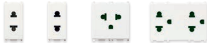
14233 2P 16 A, euro-américain (broches ø 4,8 mm). Prof. : 28 mm 14234 SICURY 2P 16 A, euro-américain (broches ø 4,8 mm). Prof. : 27 mm 14248 SICURY 2P+T 16 A, euro-américain polarisé - 2 modules. Prof. : 25,5 mm 14249 Deux prises SICURY 2P+T 16 A, euro-américain polarisé - 3 modules. Prof. : 23,5 mm
