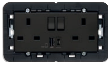
▲ 30224.ACG SICURY 2P+T 13 A, 2 interrupteurs 2P, 2 USB A+C 15 W (au total), avec support. Prof. : 27,7 mm
