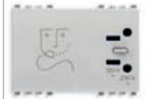
20290.N 230 V~ 50/60 Hz, avec transformateur d'isolation 20 VA, sorties 230 V~ et 120 V~ - 3 modules. Prof.: 42 mm
