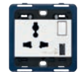
■ 19266.A.B SICURY 2P+T 13 A 250 V~ multistandard, avec interrupteur 2P et 1 USB-A. Profondeur: 21 mm
