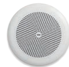
01906 Diffuseur sonore passif IP55 8 Ω 30 W, installation sur cloisons légères et faux plafonds. Prof. : 70 mm
