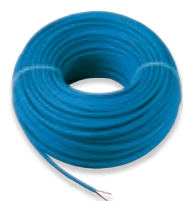
01840.E.B Câble pour diffusion sonore système Bus By-me, 2x0,50 mm 2 , avec gaine en LSZH, Classe CPR Eca, compatible pour l'installation de câbles d'énergie de catégorie I (U0 = 400 V), bleu - 100 m
