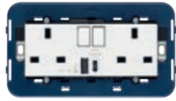
■ 19224.AC.B SICURY 2P+T 13 A 250 V~ avec 2 interrupteurs 2P, 1 USB-A et 1 USB-C. Profondeur: 21 mm
