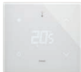
21514.F.70 Thermostat à écran tactile (chauffage et climatisation), commande VENTIL-CON- VECTEUR à 3 vitesses et proportionnelle, dispositif de contrôle de la température appartenant à la classe I (contribution 1%) en modalité ON/OFF, à la classe IV (con- tribution 2%) en modalité PID, interfaçable avec Actionneur à sorties analogiques proportionnelles 01466.1 pour réaliser un thermostat d'ambiance modulé classe V (contribution 3%), 1 entrée pour capteur électronique de température 20432, 19432 ou 14432 ou capteur de température filaire 02965.1, 1 entrée numérique programmable, rétroéclairage à LEDs RGB, blanc diamant - 2 modules. Profondeur: 30,2 mm
