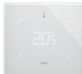
21514.H.70 Thermostat à écran tactile (chauffage et climatisation), commande MAKE UP ROOM et DO NOT DISTURB, dispositif de contrôle de la température appartenant à la classe I (contribution 1%) en modalité ON/OFF, à la classe IV (contribution 2%) en modalité PID, interfaçable avec Actionneur à sorties analogiques proportionnel- les 01466.1 pour réaliser un thermostat d'ambiance modulé classe V (contribution 3%), 1 entrée pour capteur électronique de température 20432, 19432 ou 14432 ou capteur de température filaire 02965.1, 1 entrée numérique programmable, rétroéclairage à LEDs RGB, blanc diamant - 2 modules. Profondeur: 30,2 mm
