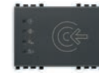
20457 Lecteur de cartes à transpondeur pour extérieur pièce, standard KNX, 2 sorties à relais NO 4 A 24 V~, 2 entrées, 12-24 V~ 50-60 Hz et 12-24 Vcc (TBTS), gris - 3 modules. Livré en série sans carte à transpondeur. Prof. : 37 mm
