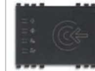
19457 Lecteur de cartes à transpondeur pour extérieur pièce, standard KNX, 2 sorties à relais NO 4 A 24 V~, 2 entrées, 12-24 V~ 50-60 Hz et 12-24 Vcc (TBTS), gris - 3 modules. Livré en série sans carte à transpondeur. Prof. : 37 mm
