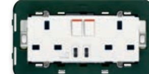
14224.CC 2 prises SICURY 2P+E 13 A, 2 interrupteurs 2P, 2 USB C+C 5 V 15 W, avec support. Prof. : 22,8 mm
