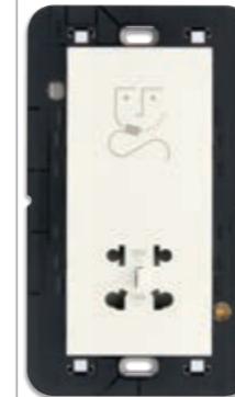
▲ 30291.B 5 230 V~ 50/60 Hz, avec transformateur d'isolation 20 VA, sortie 120/230 V~, avec support. Prof. : 44 mm
