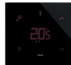
21814.H.76 Thermostat à écran tactile (chauffage et climatisation), commande MAKE UP ROOM et DO NOT DISTURB, dispositif de contrôle de la température appartenant à la classe I (contribution 1%) en modalité ON/OFF, à la classe IV (contribution 2%) en modalité PID, interfaçable avec Actionneur à sorties analogiques proportionnelles 01466.1 pour réaliser un thermostat d'ambiance modulé classe V (contribution 3%), 1 entrée pour capteur électronique de température 20432, 19432 ou 14432 ou capteur de température filaire 02965.1, 1 entrée numérique programmable, rétroéclairage à LEDs RGB, noir diamant - 2 modules. Profondeur: 30,2 mm
