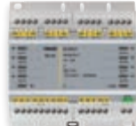
01470,1 Module 9 entrées et 8 sorties préprogrammées pour applications résidentielles ou hôtelières, sorties à relais NO 16 A 120-230 V~ 50/60 Hz programmables avec fonction éclairage, stores à lamelles orientables, commande locale, 6 modules de 17,5 mm
