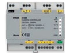
01465 Variateur de climatisation pour installations thermiques, 120-230 V~, 50/60 Hz, 3 entrées pour sondes PT100, PT1000 et NTC, 1 sortie commande vanne mélangeuse, 1 sortie 0-10 V ou (0)4-20 mA, 1 sortie à relais inverseur 16 A 230 V~, 6 modules de 17,5 mm
