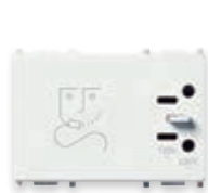
14290.AB Prise pour rasoirs 230 V~ 50/60 Hz, avec transformateur d'isolation 20 VA, sorties 230 V~ et 120 V~ - 3 modules. Prof. : 41 mm
