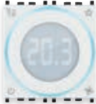
02971.B Thermostat pour domotique à molette pour le contrôle de la température ambiante (chauffage et climatisation), gestion des installations à 2 et 4 tubes, commande ventilo-convecteur à 3 vitesses et proportionnelle, dispositif de contrôle de la température classe I (contribution 1%) en mode ON/OFF, classe IV (contribution 2%) en mode PID, interfaçable avec actionneur à sorties analogiques proportionnelles 01466.1 pour réaliser un thermostat d'ambiance modulé classe V (contribution 3%), 1 entrée pour capteur électronique de température 20432, 19432 ou 14432 ou capteur de température filaire 02965.1, rétroéclairage à leds blanc
