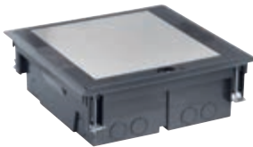
V54420.01 Colonne escamotable à poser au sol de 20 modules avec couvercle inox pour dispositifs Eikon, Arké et Plana pour pose sur plancher flottant. Livrée avec 4 supports de 5 modules. Installation sur chape avec boîte spéciale V54920
