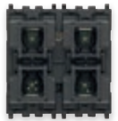
01484 4 poussoirs avec amplificateur 1+1 W RMS, 2 sorties pour haut-parleurs 8 Ω, à compléter avec des touches interchangeables - 2 modules. Prof. : 37 mm
