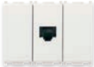
14505.AB Module relais avec prise RJ45 pour poire 2 lumières + 2 aux, branchement pour un module 8 entrées/8 sorties ou un écran Call-way, 4 sorties à relais 24 V NO, matériau antibactérien - 3 modules. Profondeur : 29,5 mm
