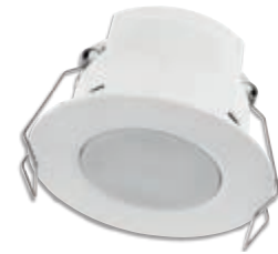
▲01527.2 Detektor s infracrvenim senzorom prisutnosti u krugu od 360° za paljenje UKLJUČIVANJA/ISKLJUČIVANJA, neprekidna regulacija grijanja, klimatizacija, ventilacija u funkciji osvjetljenja i/ili kretanja, polje podesivog osvjetljenja 1 - 1000 luxa, standard KNX, stropna instalacija. Dim. 80x80x45 mm
