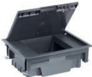
V54412.01 Kupola u ravlini s podom s poklopcem od inox čelika za aparate Eikon, Arké i Plana za instalaciju na plivaju či pod. Isporučuje se sa 2 nosača od 6 modula. Instalacija na estrih s odgovarajućom kutijom V54912
