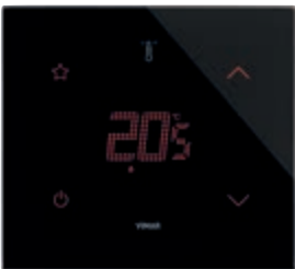
21814.S.76 Termostat sa zaslonom osjetljivim na dodir (grijanje i klimatizacija), komanda STAR koju je moguće konfigurirati, upravljački sklop za UKLJUČIVANJE/ISKLJUČIVANJE (klasa I, energetske učinkovitosti 1%), PWM, PID (klase IV, energetske učinkovitosti 2%), moguće spajanje sučeljem s aktivatorom 01466.1 za modulirajući termostat prostora (klase V, doprinos energetske učinkovitosti 3%), 1 ulaz za senzor 20432, 19432 ili 14432 ili žični senzor 02965.1, 1 programabilni digitalni ulaz, pozadinsko osvjetljenje LED RGB, dijamantno crna - 2 modula. Dubina: 30,2 mm
