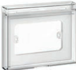
14923 Zaštićeno kućište IP44 s prozirnim vrataš- cima, 3 modula za instalaciju na ugradbenu kutiju s 3 modula. Središnji dio membrane omogućava aktiviranje komandi koje se nala- že unutar zatvorenog kućišta. Kompatibilnost s modelima Eikon Exé, Linea, Arké, Plana i glavnim rezidencijalnim serijama na tržištu
