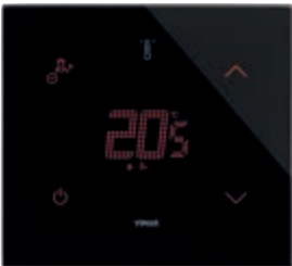
21814.H.76 Termostat sa zaslonom osjetljivim na dodir (grijanje i klimatizacija), komanda MAKE UP ROOM i DO NOT DISTURB, upravljački sklop za UKLJUČIVANJE/ISKLJUČIVANJE (klasa I, energetske učinkovitosti 1%), PWM, PID (klase IV, energetske učinkovitosti 2%), moguće spajanje sučeljem s aktivatorom 01466.1 za modulirajući termostat prostora (klase V, doprinos energetske učinkovitosti 3%), 1 ulaz za senzor 20432, 19432 ili 14432 ili žični senzor 02965.1, 1 programabilni digitalni ulaz, pozadinsko osvjetljenje LED RGB, dijamantno crna - 2 modula. Dubina: 30,2 mm
