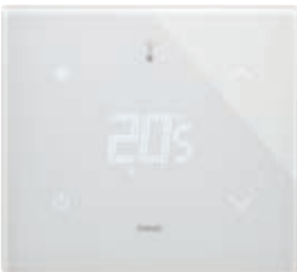
21514.F.70 Termostat sa zaslonom osjetljivim na dodir (grijanje i klimatizacija), proporcionalna komanda FAN-COIL s 3 brzine, upravljački sklop za UKLJUČIVANJE/ISKLJUČIVANJE (klasa I, energetske učinkovitosti 1%), PWM, PID (klase IV, energetske učinkovitosti 2%), moguće spajanje sučeljem s aktivatorom 01466.1 za modulirajući termostat prostora (klase V, doprinos energetske učinkovitosti 3%), 1 ulaz za senzor 20432, 19432 ili 14432 ili žični senzor 02965.1, 1 programabilni digitalni ulaz, pozadinsko osvjetljenje LED RGB, dijamantno bijela - 2 modula. Dubina: 30,2 mm
