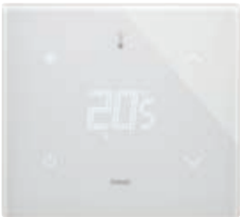
21814.F.70 Termostat sa zaslonom osjetljivim na dodir (grijanje i klimatizacija), proporcionalna komanda FAN-COIL s 3 brzine, upravljački sklop za UKLJUČIVANJE/ISKLJUČIVANJE (klasa I, energetske učinkovitosti 1%), PWM, PID (klase IV, energetske učinkovitosti 2%), moguće spajanje sučeljem s aktivatorom 01466.1 za modulirajući termostat prostora (klase V, doprinos energetske učinkovitosti 3%), 1 ulaz za senzor 20432, 19432 ili 14432 ili žični senzor 02965.1, 1 programabilni digitalni ulaz, pozadinsko osvjetljenje LED RGB, dijamantno bijela - 2 modula. Dubina: 30,2 mm
