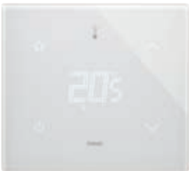
21814.S.70 Termostat sa zaslonom osjetljivim na dodir (grijanje i klimatizacija), komanda STAR koju je moguće konfigurirati, upravljački sklop za UKLJUČIVANJE/ISKLJUČIVANJE (klasa I, energetske učinkovitosti 1%), PWM, PID (klase IV, energetske učinkovitosti 2%), moguće spajanje sučeljem s aktivatorom 01466.1 za modulirajući termostat prostora (klase V, doprinos energetske učinkovitosti 3%), 1 ulaz za senzor 20432, 19432 ili 14432 ili žični senzor 02965.1, 1 programabilni digitalni ulaz, pozadinsko osvjetljenje LED RGB, dijamantno bijela - 2 modula. Dubina: 30,2 mm
