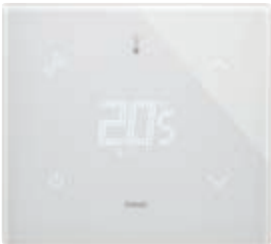
21514.H.70 Termostat sa zaslonom osjetljivim na dodir (grijanje i klimatizacija), komanda MAKE UP ROOM i DO NOT DISTURB, upravljački sklop za UKLJUČIVANJE/ISKLJUČIVANJE (klasa I, energetske učinkovitosti 1%), PWM, PID (klase IV, energetske učinkovitosti 2%), moguće spajanje sučeljem s aktivatorom 01466.1 za modulirajući termostat prostora (klase V, doprinos energetske učinkovitosti 3%), 1 ulaz za senzor 20432, 19432 ili 14432 ili žični senzor 02965.1, 1 programabilni digitalni ulaz, pozadinsko osvjetljenje LED RGB, dijamantno bijela - 2 modula. Dubina: 30,2 mm
