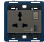
■ 19266.A.M SICURY 2P+E 13 A 250 V~ višestandardni s prekidačem 2P i USB izlazom tipa A. Dubina: 21 mm
