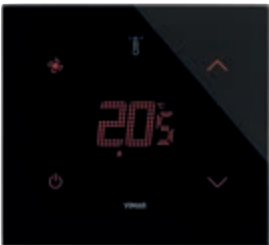
21814.F.76 Termostat sa zaslonom osjetljivim na dodir (grijanje i klimatizacija), proporcionalna komanda FAN-COIL s 3 brzine, upravljački sklop za UKLJUČIVANJE/ISKLJUČIVANJE (klasa I, energetske učinkovitosti 1%), PWM, PID (klase IV, energetske učinkovitosti 2%), moguće spajanje sučeljem s aktivatorom 01466.1 za modulirajući termostat prostora (klase V, doprinos energetske učinkovitosti 3%), 1 ulaz za senzor 20432, 19432 ili 14432 ili žični senzor 02965.1, 1 programabilni digitalni ulaz, pozadinsko osvjetljenje LED RGB, dijamantno crna - 2 modula. Dubina: 30,2 mm
