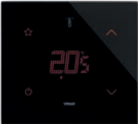
21514.S.76 Termostat sa zaslonom osjetljivim na dodir (grijanje i klimatizacija), komanda STAR koju je moguće konfigurirati, upravljački sklop za UKLJUČIVANJE/ISKLJUČIVANJE (klasa I, energetske učinkovitosti 1%), PWM, PID (klase IV, energetske učinkovitosti 2%), moguće spajanje sučeljem s aktivatorom 01466.1 za modulirajući termostat prostora (klase V, doprinos energetske učinkovitosti 3%), 1 ulaz za senzor 20432, 19432 ili 14432 ili žični senzor 02965.1, 1 programabilni digitalni ulaz, pozadinsko osvjetljenje LED RGB, dijamantno crna - 2 modula. Dubina: 30,2 mm
