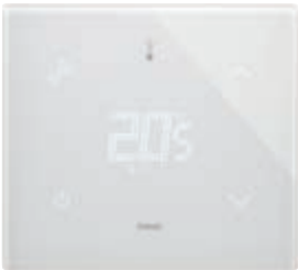
21814.H.70 Termostat sa zaslonom osjetljivim na dodir (grijanje i klimatizacija), komanda MAKE UP ROOM i DO NOT DISTURB, upravljački sklop za UKLJUČIVANJE/ISKLJUČIVANJE (klasa I, energetske učinkovitosti 1%), PWM, PID (klase IV, energetske učinkovitosti 2%), moguće spajanje sučeljem s aktivatorom 01466.1 za modulirajući termostat prostora (klase V, doprinos energetske učinkovitosti 3%), 1 ulaz za senzor 20432, 19432 ili 14432 ili žični senzor 02965.1, 1 programabilni digitalni ulaz, pozadinsko osvjetljenje LED RGB, dijamantno bijela - 2 modula. Dubina: 30,2 mm
