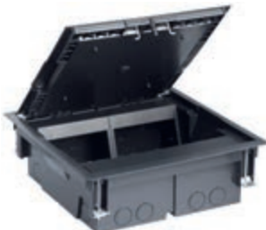
V54420.01 Kupola u ravlini s podom s poklopcem od inox čelika za aparate Eikon, Arké i Plana za instalaciju na plivaju či pod. Isporučuje se sa 2 nosača od 6 modula. Instalacija na estrih s odgovarajućom kutijom V54920
