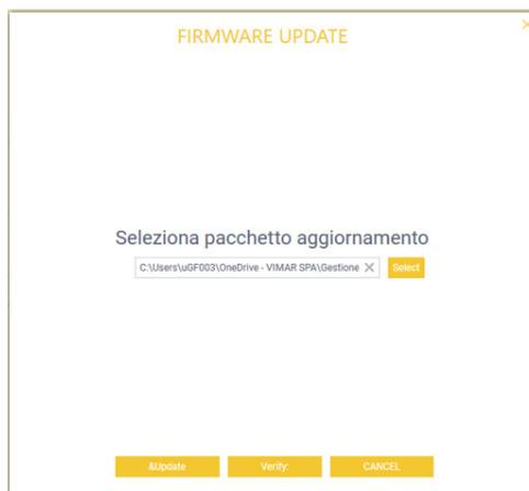
Sélectionner « VÉRIFIER » afin de confronter les versions firmware des dispositifs présents sur le système avec celles du fichier .dat. Le rapport indiquera si les versions coïncident ou la présence d'un dispositif d'une version différente.
