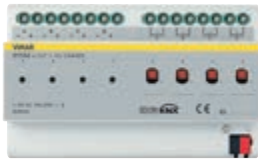
Δ01550 Regulator 4 ieșiri cu releu NO 16 A 250 V~, 4 ieșiri 0/1-10 V, butoane pentru comandă locală, standard KNX, 8 module de 17,5 mm
