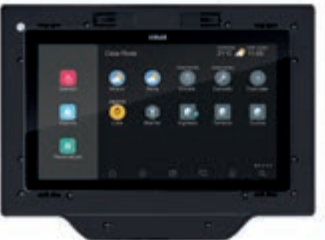
01425 Ecran tactil în culori 10" IP, utilizabil ca supraveghetor domotic, post intern videointerfon IP/Due Fili Plus, administrator telecamere IP și sisteme TVCC, PoE sau 12-30 Vdc, instalare pe perete cu suport pe cutie rotundă, dreptunghiulară 3 module (orizontal și vertical), 8 module (4+4) și pătrată BS, negru
