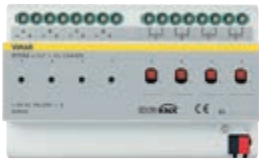
▲01550.1 Dimmer 4 ieșiri cu releu NO 16 A 250 V~, 4 ieșiri 1-10 V, butoane pentru comandă locală, standard KNX Secure, instalare pe șină DIN (60715 TH35), ocupă 8 module de 17,5 mm
