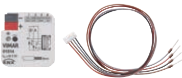
01514 Interfață cu 2 canale programabile ca intrări sau ca ieșiri pentru LED, standard KNX, dimensiuni: 39,1x40x12,3 mm
