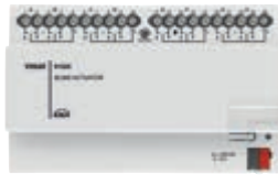
01525 Actuator pentru 8 jaluzele cu ieșire cu releu 6 A 230 V~ 50/60 Hz, standard KNX, 8 module x 17,5 mm
