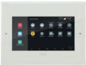
01422.B*** Ecran tactil în culori 7" IP, utilizabil ca supraveghetor domotic, post intern videointerfon IP/Due Fili Plus, administrator telecamere IP și sisteme TVCC, PoE sau 12-30 Vdc, instalare pe perete cu suport pe cutie rotundă, dreptunghiulară 3 module (orizontală și verticală), 8 module (4+4) și pătrată BS, alb
