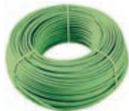
01890.C Cabluri pentru sistemul KNX, 2x2x0,8 mm, izolator și înveliș LSZH, clasă CPR Cca s1b d1 a1, adecvată pentru instalarea cu cabluri de Categorie I (U0 = 400 V), verde - 100 m
