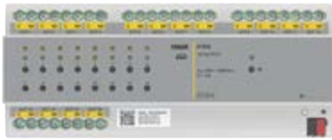
01532 Actuator 16 ieșiri cu releu NO 10 A 230 V~ 50/60 Hz, standard KNX Secure, instalare pe șină DIN (60715 TH35), ocupă 12 module de 17,5 mm
