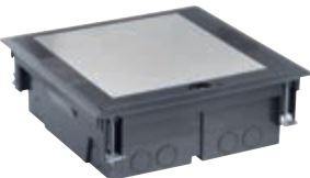
V54420.01 Doză ascunsă de pardoseală de 20 de module, cu capac inox, pentru aparate Eikon, Arké și Plana, pentru instalare pe pardoseală flotantă. Dotată cu 4 suporturi de 5 module. Instalare pe șapă cu casetă specială V54920
