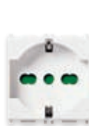
14210.AB Priză SICURY 2P+T 16 A 250 V~ universală - 2 module. Adâncime: 25 mm
