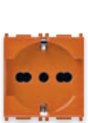
14210.AB.A Priză SICURY 2P+T 16 A 250 V~ universală, portocalie - 2 module. Adâncime: 25 mm
