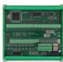
02096 Placă cu 8 intrări, 8 ieșiri, 8 module de 17,5 mm
