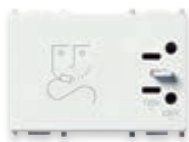
14290.AB Priză pentru aparate de ras 230 V~ 50/60 Hz, cu transformator de izolare 20 VA, ieșiri 230 V~ și 120 V~ - 3 module. Adâncime: 41 mm
