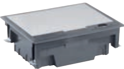
V54912.01 Doză ascunsă de pardoseală cu capac inox, pentru aparate Eikon, Arké și Plana, pentru instalare pe pardoseală flotantă. Dotată cu 2 suporturi de 6 module. Instalare pe șapă cu casetă specială V54912
