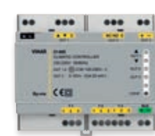
01465 Klimatski regulator za toplinske instalacije, 120-230 V~ 50/60 Hz, 3 ulaza za sonde PT100, PT1000 i NTC, 1 izlaz komande ventila za miješanje, 1 izlaz 0-10 V ili (0)4-20 mA, 1 relejni izlaz za prespajanje 16 A 230 V~, 6 modula od 17,5 mm
