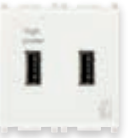
14295 5 V 10,5 W, 2 USB A za ukupno 2,1 A, 120-230 V~ 50/60 Hz - 2 modula. Dubina: 36 mm
