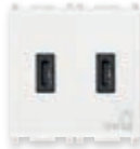
14295.CC 5 V 15 W, 2 USB C za ukupno 3 A, 120-240 V~ 50/60 Hz - 2 modula. Dubina: 29 mm
