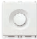
14433 Elektronički senzor vlage 12/24 V, 1 izlaz 0-10 V ili 4-20 mA - 2 modula Dubina: 36 mm
