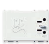
14290.AB Utičnica za brijače aparate 230 V~ 50/60 Hz, s izolacijskim transformatorom 20 VA, izlazi 230 V~ i 120 V~ - 3 modula. Dubina: 41 mm
