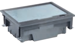
V54412 Kupola u ravlini s podom sa šupljim poklopcem za aparate Eikon, Arké i Plana za instalaciju na plivajući pod. Isporučuje se s 2 nosača od 6 modula. Instalacija na estrih s odgovarajućom kutijom V54912
