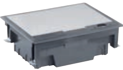
V54912.01 Kupola u ravlini s podom s poklopcem od inox čelika za aparate Eikon, Arké i Plana za instalaciju na plivajući pod. Isporučuje se s 2 nosača od 6 modula. Instalacija na estrih s odgovarajućom kutijom V54912
