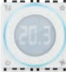
02971.B Termostatski za domotiku s kotačićem za kontrolu temperature u prostoru (grijanje i klimatizacija), upravljanje sustavima s 2 i 4 cijevi, komanda s ventilokonvektorom s 3 brzine i proporcionalna, uređaj za kontrolu temperature klase I (doprinos energetske učinkovitosti 1%) u načinu rada ON/OFF, klase IV (doprinos energetske učinkovitosti 2%) u načinu rada PID, moguće povezivanje sučeljem s proporcionalnim analognim izlazima 01466.1 za realizaciju prostornog modulacijskog termostata klase V (doprinos energetske učinkovitosti 3%), 1 ulaz za elektronički senzor temperature 20432, 19432 o 14432 ili žični senzor temperature 02965.1, bijelo pozadinsko led osvjetljenje
