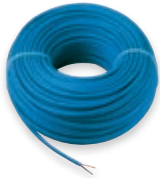
01840.E.B Kabel za razglas sustava Bus By-me, 2x0,50 mm², s oblogom od materijala LSZH, klasa CPR Eca, prikladan za instalacije s energetskim kabelima kategorije I (U0 = 400 V), plavi - 100 m
