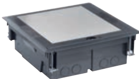
V54420.01 Caja escamoteable de suelo de 20 módulos con tapa inoxidable para aparatos Eikon, Arké y Plana, para montaje en suelo flotante. Se suministra con 4 soportes de 5 módulos. Montaje sobre recrecido con caja especial V54920
