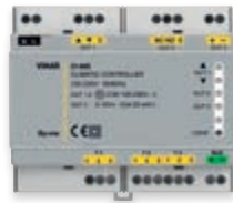
01465 Variador climático para instalaciones térmicas, 120-230 V~ 50/60 Hz, 3 entradas para sondas PT100, PT1000 y NTC, 1 salida control válvula mezcladora, 1 salida 0-10 V o (0)4-20 mA, 1 salida de relé conmutada 16 A 230 V~, 6 módulos de 17,5 mm
