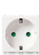
14208.AB Toma SICURY 2P+T 16 A 250 V~, estándar alemán - 2 módulos. Profundidad: 28,4 mm
