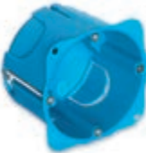
V71701 Redonda ø 60 mm (GW 850 °C), azul claro, apta solo para soportes sin garras
