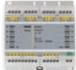
01470,1 Módulo 9 entradas y 8 salidas preprogramadas para aplicaciones residenciales u hoteleras, salidas de relé NO 16 A 120-230 V~ 50/60 Hz programables con función luces, persianas con orientación de láminas, control local, 6 módulos de 17,5 mm
