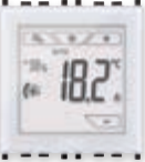
02951.B Termostato con pantalla táctil (calefacción y aire acondicionado), gestión de instalaciones de 2 y 4 tubos, accionamiento de fan-coil de 3 velocidades y proporcional, dispositivo de control de la temperatura de clase I (aportación 1%) en modo ON/OFF, de clase IV (aportación 2%) en modo PID, 1 entrada para sensor NTC de temperatura cableado o de empotrar, retroiluminación de led RGB, conectable mediante actuador con salidas analógicas proporcionales 01466 para realizar un termostato de ambiente modulante de clase V (aportación 3%) - 2 módulos
