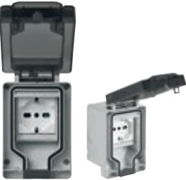
14962.U Toma SICURY 2P+T 16 A 250 V~ universal estándar italiano P40 en caja de superficie estanca IP66 con clavija insertada, blanca - 2 módulos
