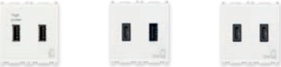
14295 5 V 10,5 W, 2 USB A por un total de 2,1 A, 120-230 V~ 50/60 Hz - 2 módulos. Profundidad: 36 mm 14295.AC 5 V 15 W, USB A+C por un total de 3 A, 120-240 V~ 50/60 Hz - 2 módulos. Profundidad: 29 mm 14295.CC 5 V 15 W, 2 USB C por un total de 3 A, 120-240 V~ 50/60 Hz - 2 módulos. Profundidad: 29 mm
