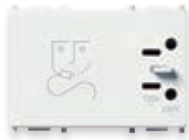
14290.AB Tomas para afeitadora 230 V~ 50/60 Hz, con transformador de aislamiento 20 VA, salidas 230 V~ y 120 V~ - 3 módulos. Profundidad: 41 mm
