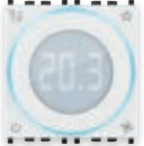
02971.B Termostato para domótica con mando giratorio para control de la temperatura ambiente (calefacción y aire acondicionado), gestión de instalaciones con 2 y 4 tubos, mando Fan-coil de 3 velocidades y proporcional, dispositivo de control de la temperatura de clase I (aportación 1%) en el modo ON/OFF, de clase IV (aportación 2%) en el modo PID, interconectable con actuador con salidas analógicas proporcionales 01466.1 para realizar un termostato ambiente modulante de clase V (aportación 3%), 1 entrada para sensor electrónico de temperatura 20432, 19432 o 14432 o sensor de temperatura cableado 02965.1, retroiluminación de LED blanco, Next
