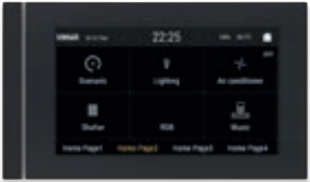
01560 Touch screen a colori 5 " per controllo e comando domotica standard KNX, completo di supporto per installazione in scatole 2-3 moduli, nero
