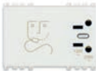
19290.AB.B Presa per rasoi con trasformatore d'isolamento 20 VA, 230 V~ 50/60 Hz, uscite 230 V~ e 120 V~, bianco - 3 moduli. Prof.tà: 42 mm
