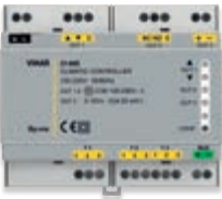
01465 Regolatore climatico per impianti termici, 120-230 V~ 50/60 Hz, 3 ingressi per sonde PT100, PT1000 e NTC, 1 uscita comando valvola miscelatrice, 1 uscita 0-10 V o (0)4-20 mA, 1 uscita a relé in scambio 16 A 230 V~, 6 moduli da 17,5 mm
