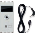
20584.1.N Per trasmissione comandi By-me Plus a ricevitore IR, con cavetto 3 m, Next. Prof.tà: 40 mm
