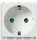
14208.AB Presa SICURY 2P+T 16 A 250 V~ standard tedesco, bianco - 2 moduli. Prof.tà: 28,4 mm
