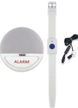
03890 Dispositivo vivavoce di telesoccorso per chiamata via rete cellulare LTE di numeri predefiniti. La chiamata vivavoce viene avviata premendo il pulsante "Alarm" o tramite il pulsante dell'accessorio bracciale/pendaglio. Il dispositivo consente anche la ricezione di chiamate esterne con risposta automatica
