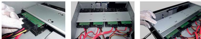
3 - Installare i quattro HDD superiori e reinstallare il coperchio.
