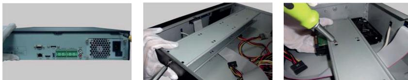
2 - Collegare i cavi di alimentazione e dati e installare gli altri HDD seguendo il metodo sopra citato e reinstallare la barra di montaggio superiore.
