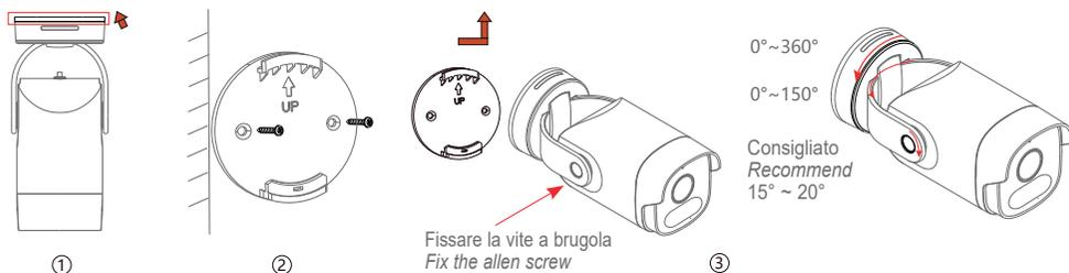
**Note di installazione:** per evitare che le immagini risultino sovraesposte, evitare l'installazione della telecamera in condizioni di controllo luce o luce eccessiva.
