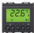
16915 Termostato para control de temperatura ambiente con 2 zonas independientes (calefacción y acondicionamiento), estándar KNX, salida de relé NO 4 A 24 V~ + 1 entrada con sensor de temperatura + 1 entrada programable - 2 módulos. Profundidad: 36,5 mm
