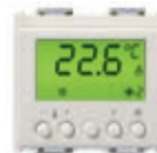
16915.B Termostato para control de temperatura ambiente con 2 zonas independientes (calefacción y acondicionamiento), estándar KNX, salida de relé NO 4 A 24 V~ + 1 entrada con sensor de temperatura + 1 entrada programable - 2 módulos. Profundidad: 36,5 mm
