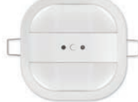
01529.1 Detector de presencia IR de 360°, ON/OFF luces, alcance de luminosidad 1-1000 Lux, estándar KNX, para la instalación de techo. Dimensiones: 91x91x45 mm
