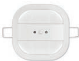
01527 Detector de presencia IR de 360°, ON/OFF y regulación de luces, calefacción, climatización, ventilación, alcance de luminosidad 1-1000 Lux, estándar KNX, para la instalación de techo. Dimensiones: 80x80x45 mm
