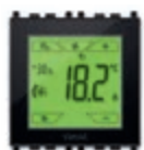
02952 Termostato táctil para control de temperatura ambiente de 2 zonas independientes, estándar KNX, salida de relé NO 4 A 24 V~ + 1 entrada con sensor de temperatura + 1 entrada digital programable - 2 módulos. Montaje con soporte específico 16723. Profundidad: 38,5 mm
