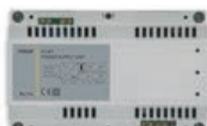
01401 Alimentador, salida 29 Vdc 1280 mA, 120-230 V~ 50/60 Hz, 8 módulos x 17,5 mm
