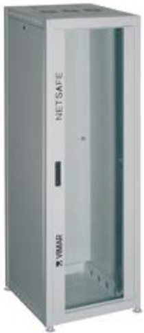
03242.4 Fino a 42 unità rack, singola coppia di montanti anteriori, appoggio su piedini regolabili, RAL 7035. Dim.: 640x640x2018 mm, peso 82 Kg
