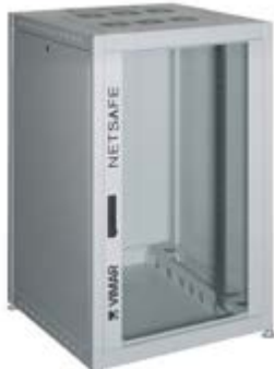
03225.4 Fino a 25 unità rack, singola coppia di montanti anteriori, appoggio su piedini regolabili, RAL 7035. Dim.: 800x800x1263 mm, peso 77 Kg
