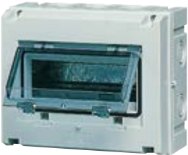
V51008 8 moduli, con tappi per il doppio isolamento, completo di guida DIN (60715 TH35), grigio RAL 7035, con portello trasparente fumé. Potenza dissipata: 21 W
