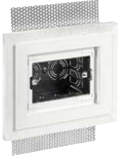
V71796 Scatola da incasso 7 moduli (GW 960 °C) con cornice in gesso per installazione filomuro di placche Eikon Exé su pareti leggere
