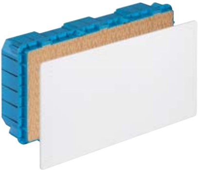
V70211 Con coperchio bianco, coperchio paramalta e viti di fissaggio. Dimensione scatola: 515x248x120 mm, 4 separatori in dotazione. Potenza dissipata: 69 W
