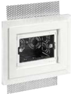
V71794 Scatola da incasso 4 moduli (GW 960 °C) con cornice in gesso per installazione filomuro di placche Eikon Exé su pareti leggere
