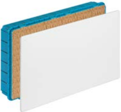
V70011 Con coperchio bianco, coperchio paramalta e viti di fissaggio. Dimensione scatola: 515x292x80 mm, 5 separatori in dotazione. Potenza dissipata: 64 W
