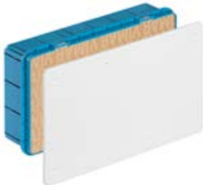
V70007 Con coperchio bianco, coperchio paramalta e viti di fissaggio. Dimensione scatola: 287x154x70 mm Potenza dissipata: 24 W
