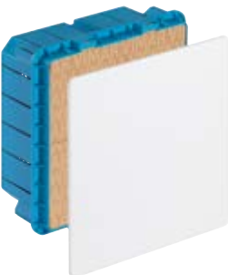
V70207 Con coperchio bianco, coperchio paramalta e viti di fissaggio. Dimensione scatola: 248x248x120 mm, 1 separatore in dotazione. Potenza dissipata: 26 W
