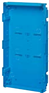
V53336 Scatola per pareti in muratura - 36 moduli, (GW 650 °C) Potenza dissipata: 50 W
