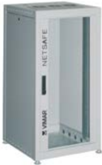
03224.4 Fino a 25 unità rack, singola coppia di montanti anteriori, appoggio su piedini regolabili, RAL 7035. Dim.: 640x640x1263 mm, peso 57 Kg
