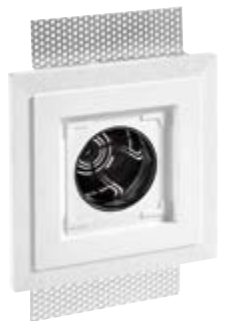
V71791 Scatola da incasso rotonda ø 60 mm (GW 960 °C) con cornice in gesso per installazione filomuro di placche 2 moduli Eikon Exé su pareti leggere
