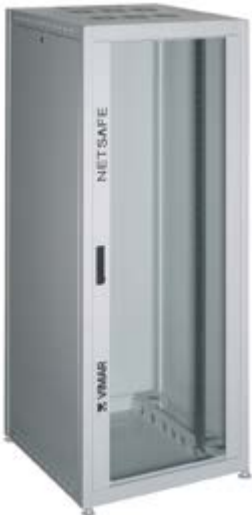
03243.4 Fino a 42 unità rack, singola coppia di montanti anteriori, appoggio su piedini regolabili, RAL 7035. Dim.: 800x800x2018 mm, peso 107 Kg
