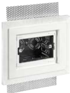
V71793 Scatola da incasso 3 moduli (GW 960 °C) con cornice in gesso per installazione filomuro di placche Eikon Exé su pareti leggere
