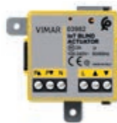
03982 Actuador para 1 persiana con orientación de láminas con salida de relé conmutada para motor cosφ 0,6 2 A 100-240 V~ 50/60 Hz, control de remoto, Bluetooth® wireless technology 5.0 para sistema mesh View Wireless y Zigbee 3.0
