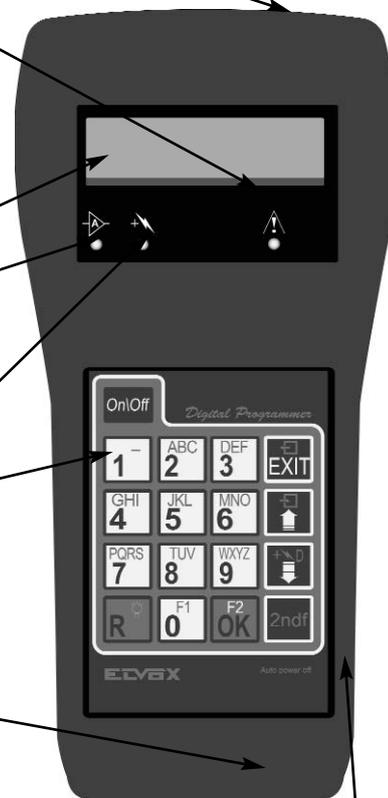
Vano batterie (nella parte posteriore). Possono essere alloggiare 2 batterie a 9Vd.c. (anche di tipo ricaricabile). Le batterie non sono obbligatoriamente necessarie.
