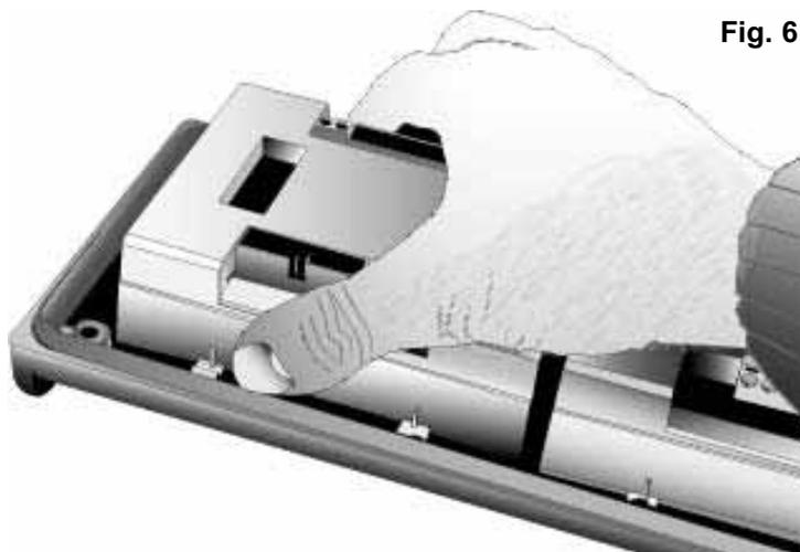
**Fig. 7 -** Nel modulo a pulsanti, effettuare una leggera pressione con le dita per togliere il fermacartellino.
