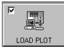
Per caricare la forma d'onda campionata dal 950B è sufficiente (verificare la connessione seriale) premere il tasto al lato ("LOAD PLOT"). Viene allora caricata e visualizzata la traccia, nonché sono aggiornati sullo schermo tutti i parametri corrispondenti rilevati dal 950B (tempi e livelli di trigger).
