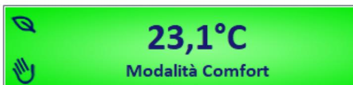
La maggior parte delle informazioni di stato del termostato sono fornite dal pannello di stato del widget semplificato, mentre il valore del setpoint di temperatura corrente e la velocità del fan coil (per i sistemi che prevedono la gestione) sono forniti nelle relative sezioni dedicate del widget.
