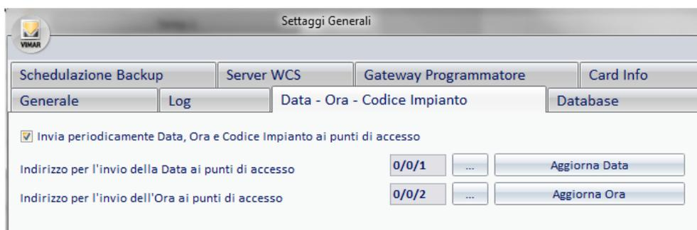
Se abilitata la funzione "Invia periodicamente Data, Ora e Codice Impianto ai punti di accesso", si abilita automaticamente anche il campo per l'impostazione dell'intervallo di tempo.
