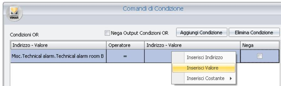
Compare una finestra per l'impostazione del valore (in base al tipo di indirizzo la finestra può proporre la selezione di alcuni valori oppure un campo testo in cui inserire il valore numerico o testuale).
