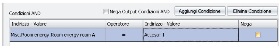
Come già anticipato, il risultato di ogni riga della lista delle condizioni in AND è "messo in AND" con il risultato della successiva riga, fino all'esaurimento delle righe della lista suddetta.
