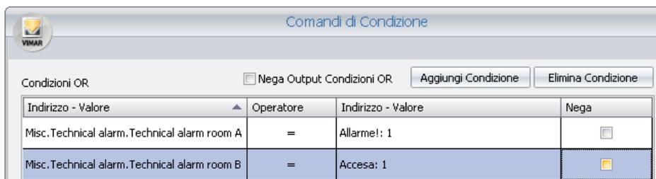
Come già anticipato, il risultato di ogni riga della lista delle condizioni in OR è "messo in OR" con il risultato della successiva riga, fino all'esaurimento delle righe della lista suddetta.
