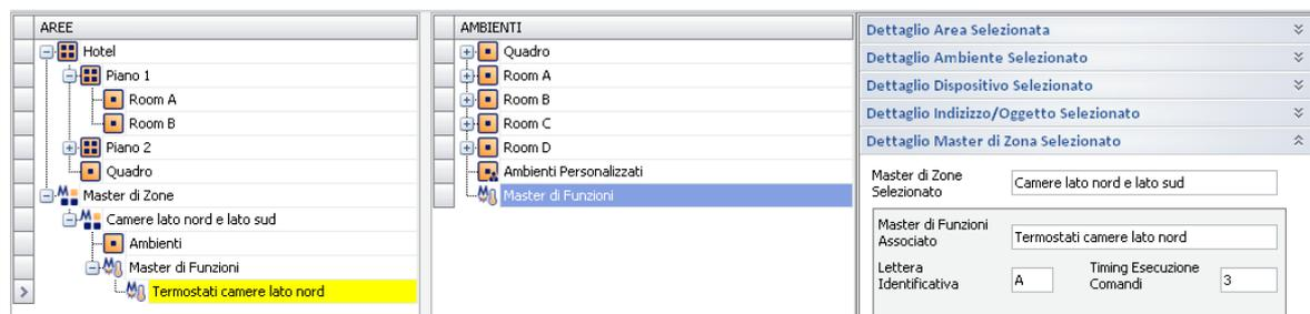
Nella sezione “Dettaglio Master di Zona Selezionato” è possibile impostare i dati di configurazione del master di funzioni (per la descrizione di tali dati fare riferimento al capitolo *Configurazione dei “Master di funzioni”*).
