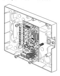
4. Den Deckel anbringen und das Gehäuse 01714 schließen.
