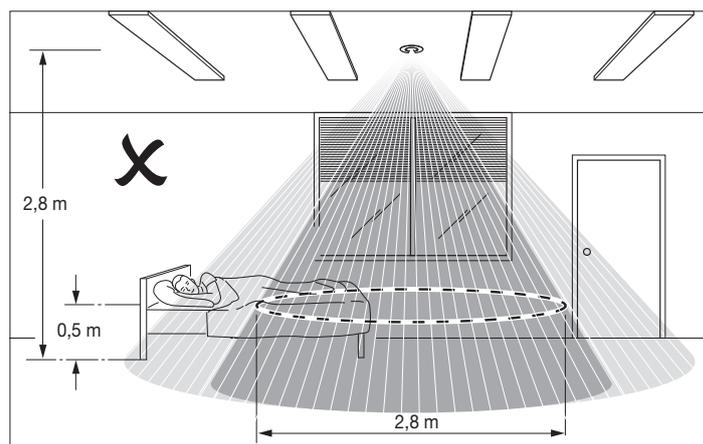
**IMPORTANT** La chute peut être détectée uniquement si le capteur est installé sur une surface plane, à une hauteur minimale de 2,4 m ; installer le capteur de façon à ce que le faisceau soit vertical. Au redémarrage du dispositif, la fonction chute est active au bout d'une minute avec un champ de détection libre.
