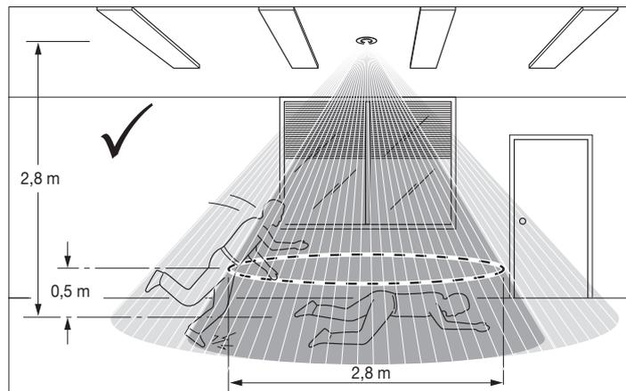
ATTENTION : Dans certains cas, le capteur peut également détecter une chute si des objets sont posés entre le cône de détection des chutes et le cône de détection des permanences et/ou si des enfants et des animaux domestiques passent à l'intérieur du cône de détection.
