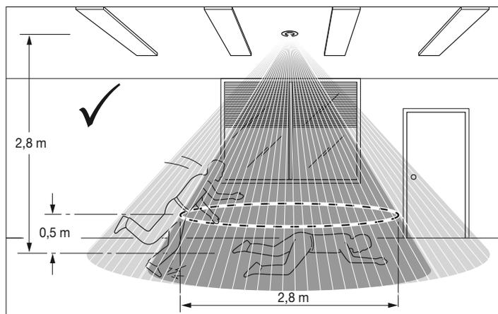
**ATTENZIONE:** In alcuni casi l'evento di caduta potrebbe essere rilevato anche con soggetti che stazionano tra il cono di rilevazione caduta e il cono di rilevazione presenza e/o con la permanenza di bambini e animali domestici all'interno del cono di rilevazione.
