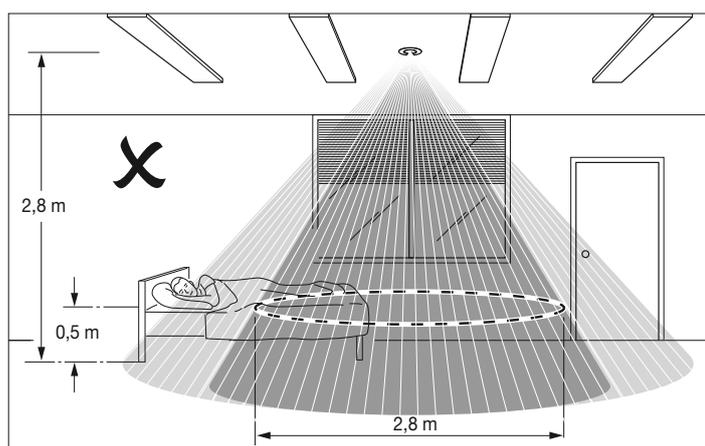
**IMPORTANTE:** La caduta viene rilevata solo se il sensore è installato sopra ad una superficie piana ad una altezza minima di 2,4m; installare il sensore in modo tale che il fascio sia verticale. Al riavvio del dispositivo la funzione caduta sarà attiva dopo un minuto con campo di rilevazione libero.
