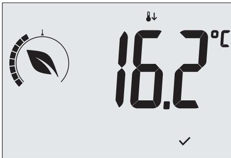
Fig. 9: Entrada en el modo Reducción de temperatura nocturna con indicación del valor de ajuste
