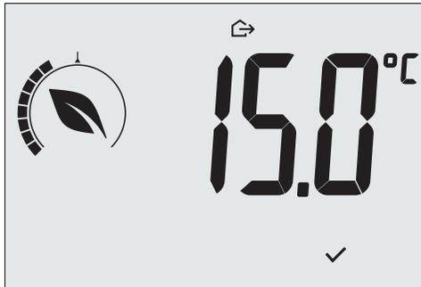
Fig. 7: Entrada en el modo usuario ausente con indicación de la temperatura programada
