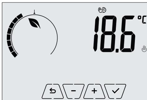
Fig. 8: Pantalla de paso al modo Manual temporizado
