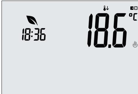
Abb. 22: Übergang in den ferngeschalteten reduzierten Betrieb
