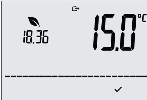
Abb. 19: Übergang in die Betriebsart Abwesenheit mit Anzeige der Abwesenheitstemperatur
