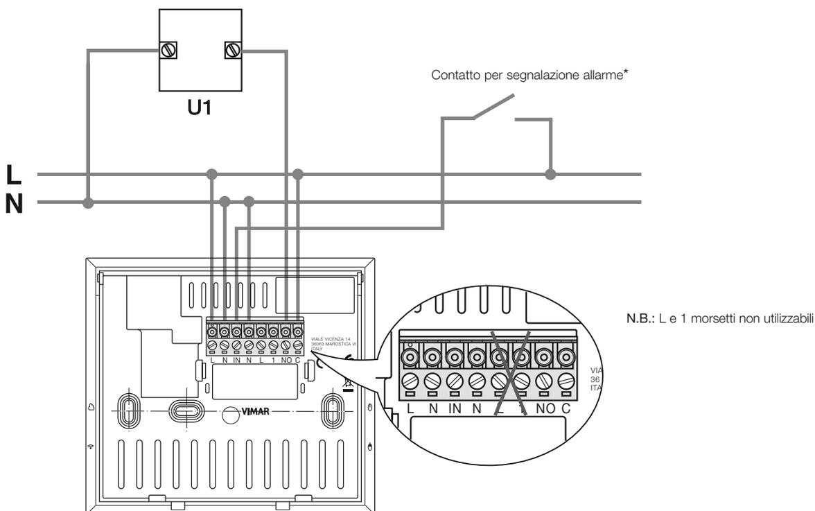
\* Genera una notifica di allarme ma non disattiva il relè di uscita (NO-C)
