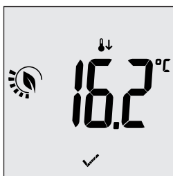
Abb. 11: Übergang in den Reduzierten Nachtbetrieb mit Anzeige des reduzierten Sollwerts
