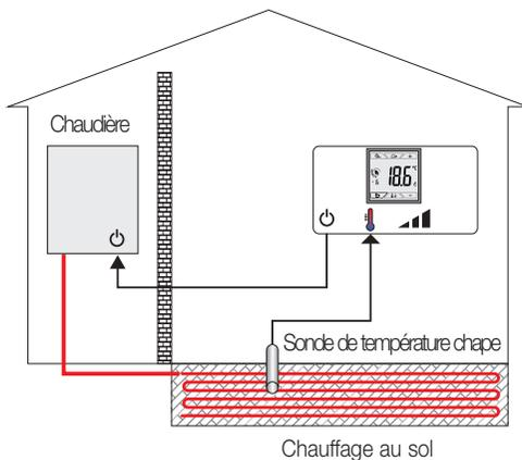
**IMPORTANT :** En cours d'installation, veiller à ne pas endommager l'isolation de la sonde durant la préparation de la chape. Procéder à l'installation de sorte à pouvoir accéder à la sonde pour toute opération d'entretien.
