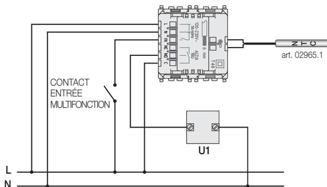
Fig. 1 : Connexion relais et entrée multifonction
