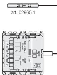
Fig. 2 : Connexion de la sonde de température extérieure
