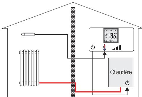
02965.1 utilisée pour limiter la température du chauffage au sol
