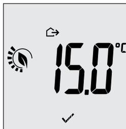
Fig. 7: Entrada en el modo usuario ausente con indicación de la temperatura programada
