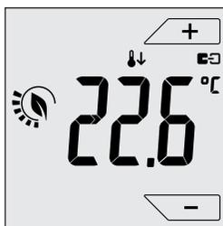
Fig. 12: Entrada en el modo Reducción de temperatura a distancia
