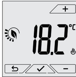
Fig. 6: Configuración del valor de ajuste manual
