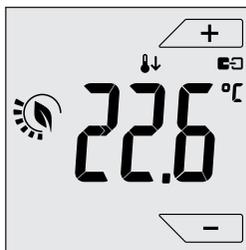
Fig. 12 : Accès au mode Réduction à distance
