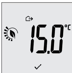
Fig. 7 : Accès au mode Absence avec indication de la température d'absence
