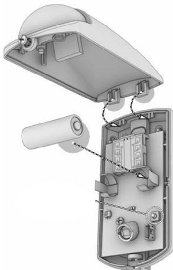
2. Die Schraube lösen und den Deckel von der Basis nehmen.
