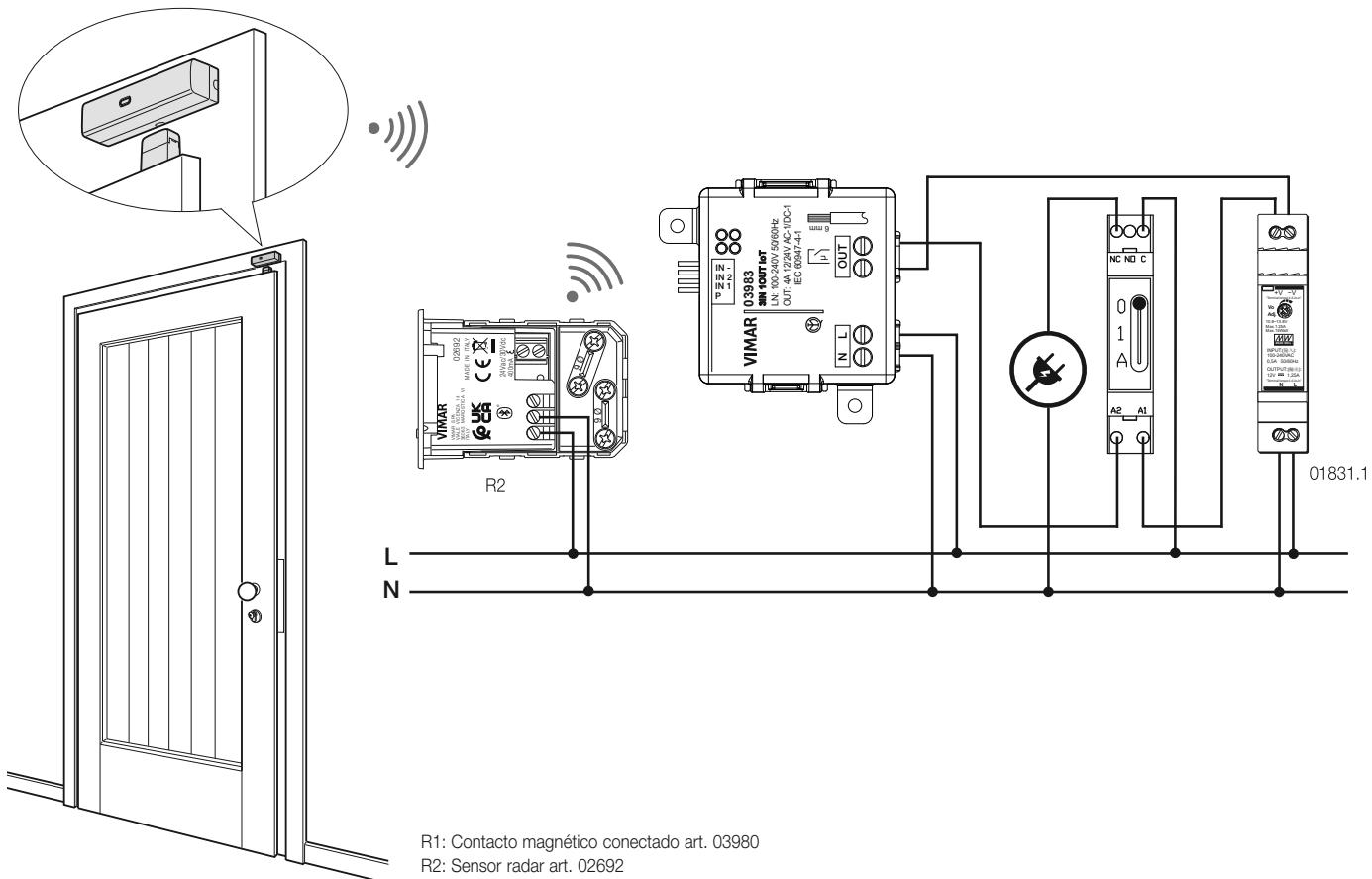
Esta tipología de conexión permite configurar el módulo 03983 como un sensor lógico de presencia, que comunica por Bluetooth con los sensores View Wireless (contacto magnético 03980 y sensor radar 02692).
