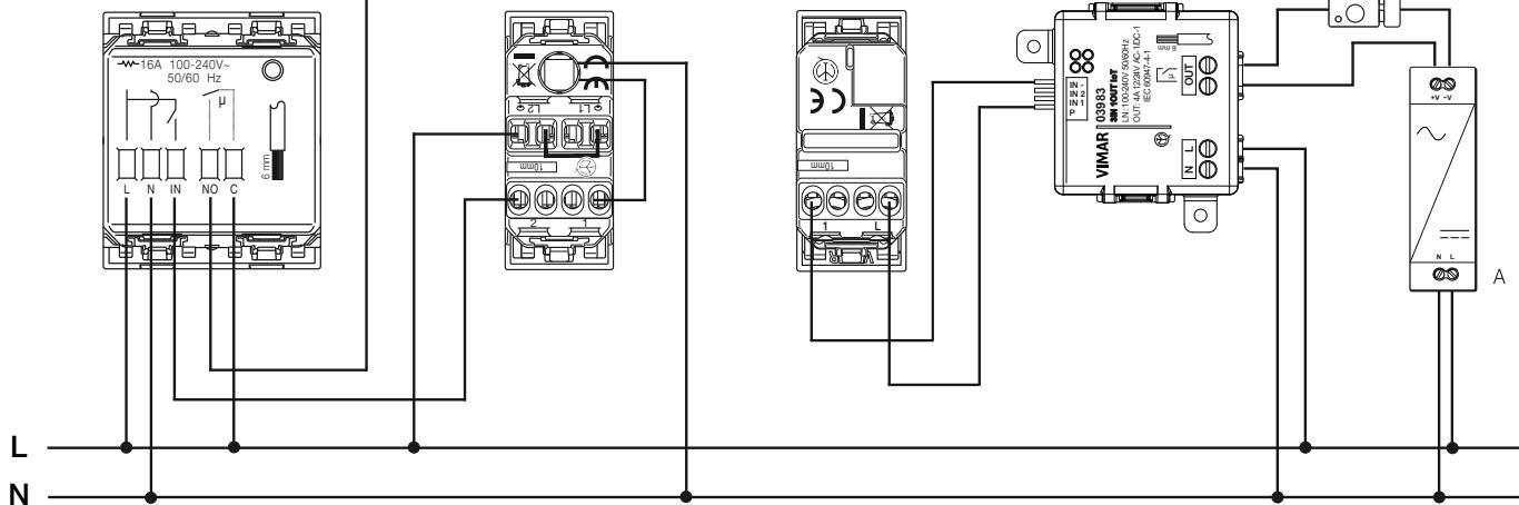
**CONEXIÓN PARA APERTURA PUERTA BASCULANTE**
