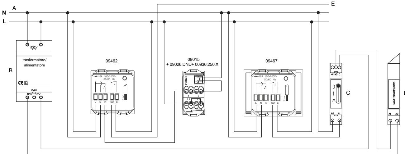
A: Da magnetoermico di camera • From room RCBO • Depuis interrupteur magnétothermique de chambre • Desde magnetotérmico en la habitación
