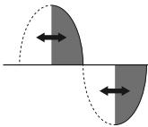
Gradation par coupure en fin d'phase TE
