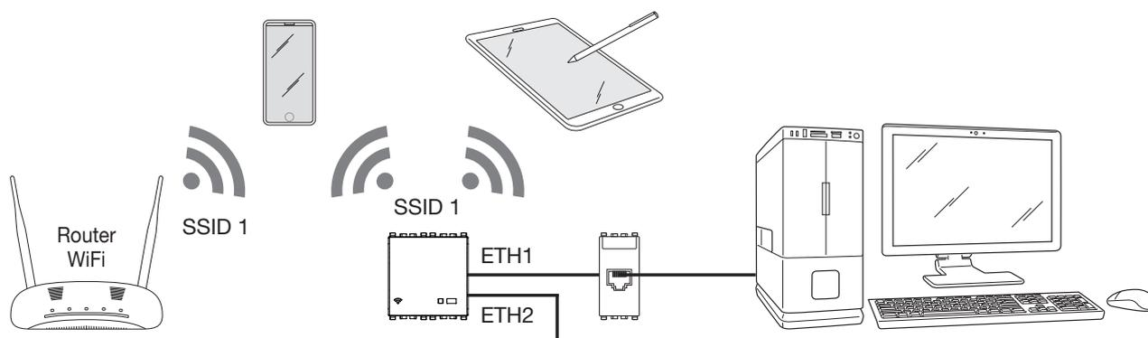
In questo caso è necessario impostare nel dispositivo l'SSID, il tipo di Sicurezza e la Chiave della rete wireless che si desidera estendere.
