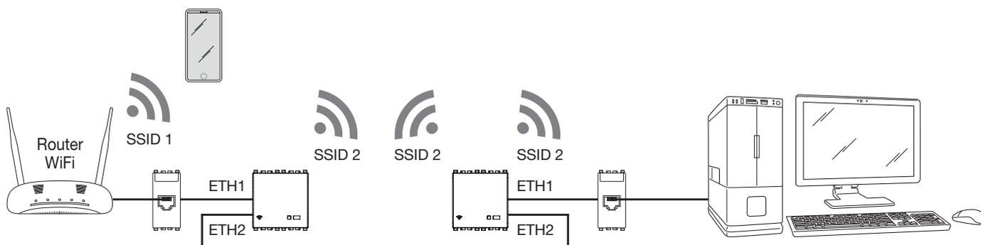
Per realizzare questa configurazione è necessario disporre di due Access Point:
