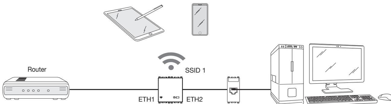
Selezionare "Configurazione" e modalità "Access point WiFi"; si consiglia di modificare la password e impostare un SSID personalizzato a seconda dell'esigenza.
