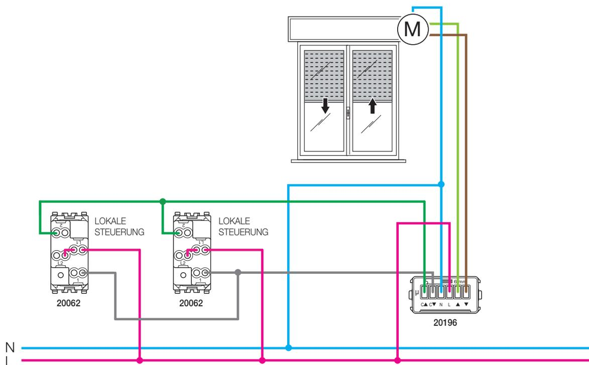
ANSCHLUSS FÜR ZENTRALISIERTE ROLLLADEN-STEUERUNG MIT 20196-19196-14196 und 03996
