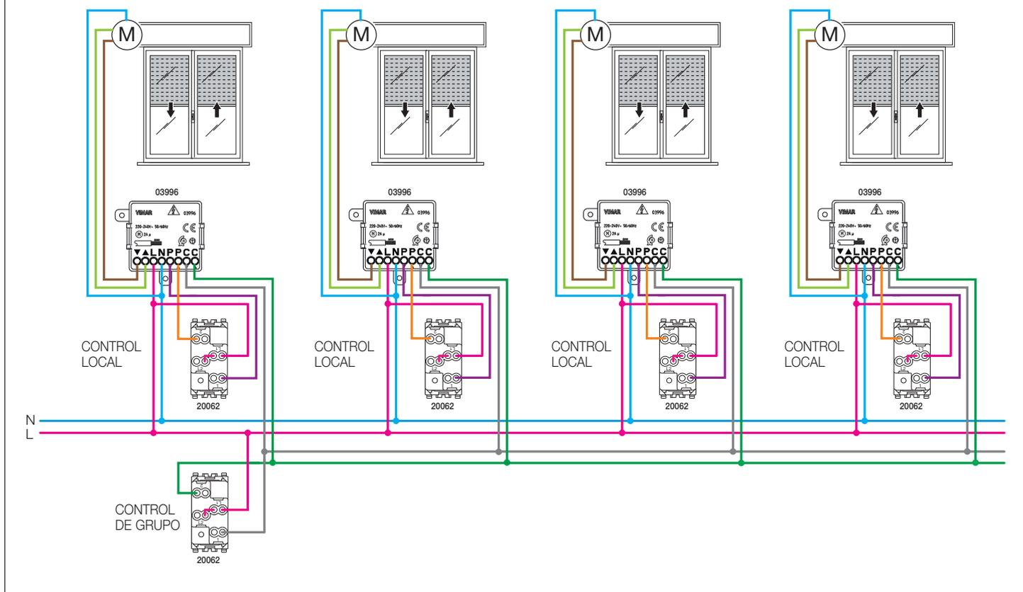
CONEXIÓN CON 03997 PARA CONECTAR EL CONTROL LOCAL ADICIONAL A 20196-19196-14196
