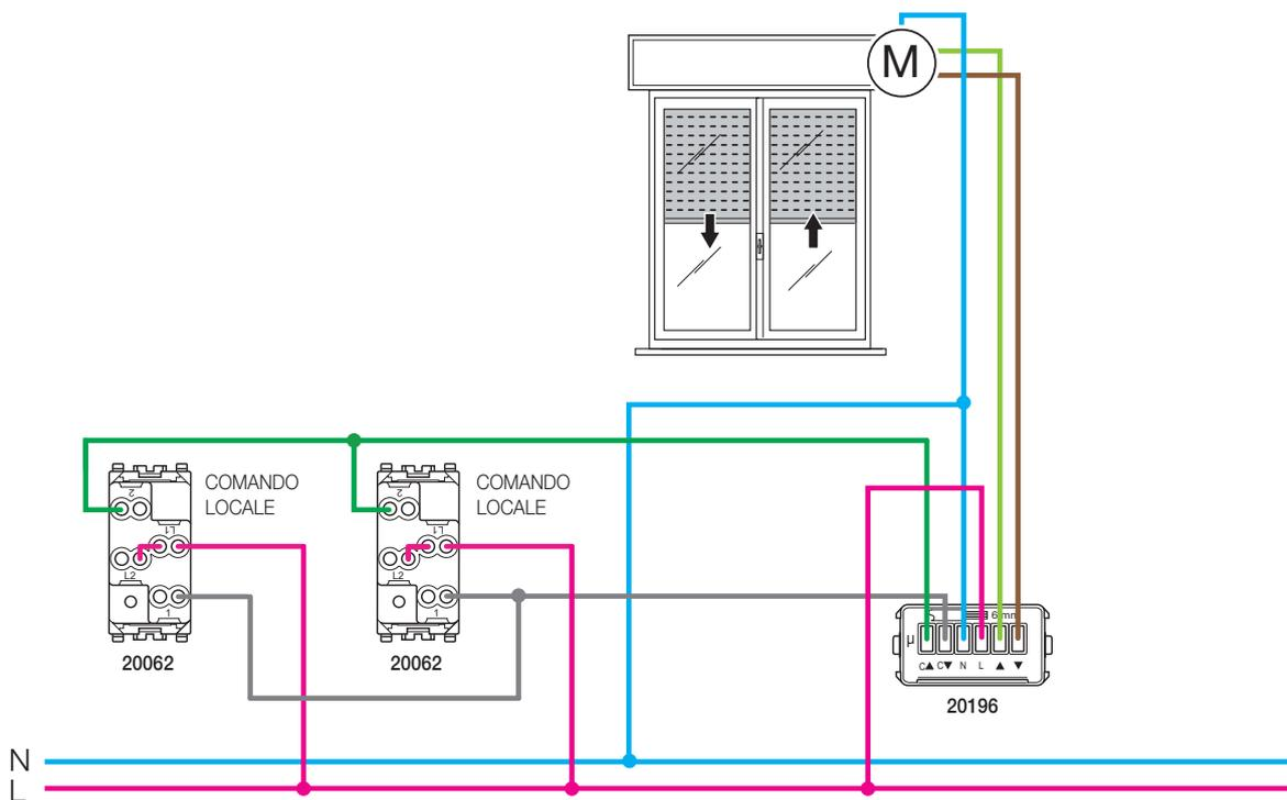
COLLEGAMENTO CENTRALIZZAZIONE TAPPARELLE CON 20196-19196-14196 e 03996
