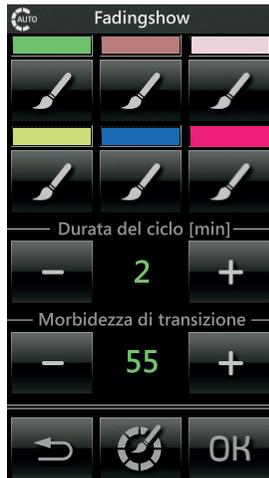
La funzione di Fading-show permette di impostare una sequenza ciclica di colori (fino ad un massimo di 6) per realizzare variazioni cromatiche e giochi di luce negli ambienti dove sono installate le lampade RGB.
